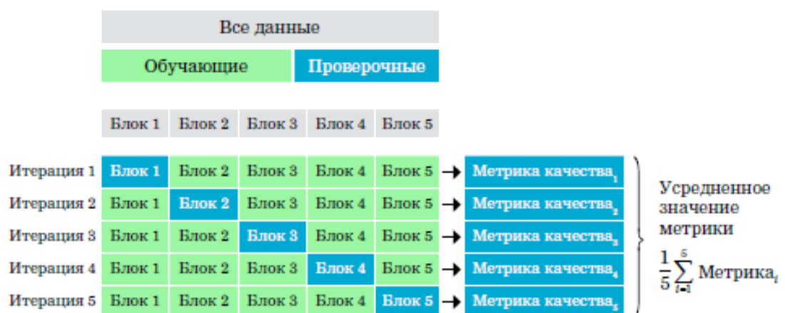
Схема 5. Пример работы перекрестной проверки K Fold Cross Validation
