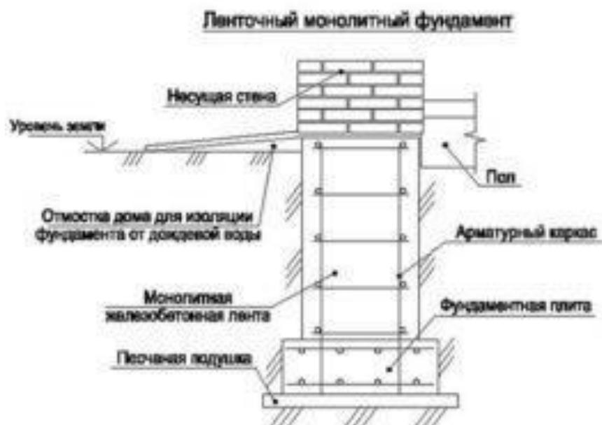
Рисунок 24. Конструкция фундамента
