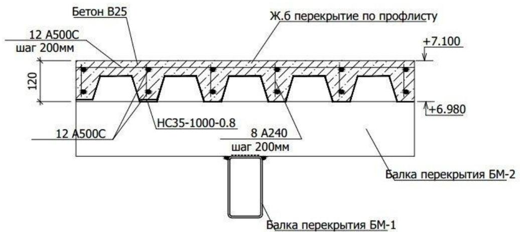
Рисунок 34. Устройство несъемной опалубки перекрытия
