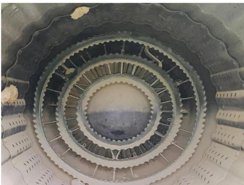
Рисунок 1.1 – Камера сгорания Миг – 21 [1]
