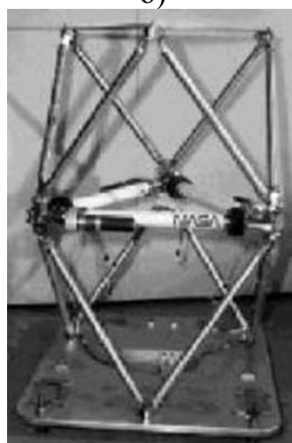
1.7 Сурет - Ғарыштық қолдану үшін параллельді құрылым құрылғыларының мысалдары
