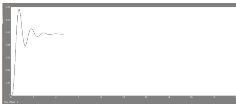
2.20 Сурет - K_y = 1 , K_{oc} = 20 , K_{moc} = 3 кезіндегі модельдеу нәтижелері
