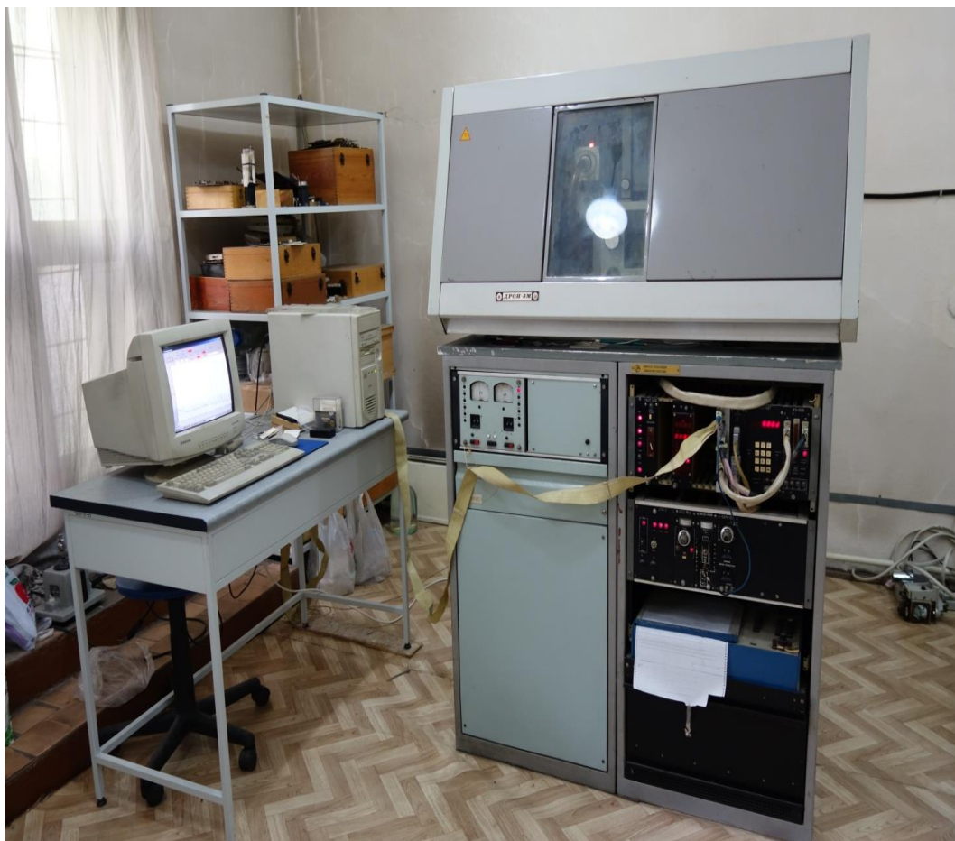
Сурет 2.5 – РФА талдауын жасайтын «ДРОН – 4М» дифрактометрі
