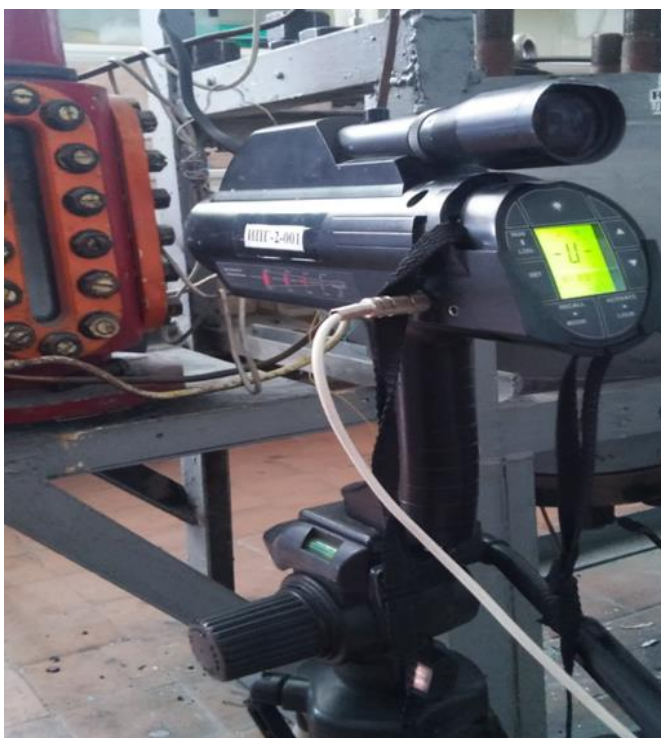
Сурет 2.4 – ӨЖС температурасын өлшейтін «Raytek Zi» оптикалық пирометр
