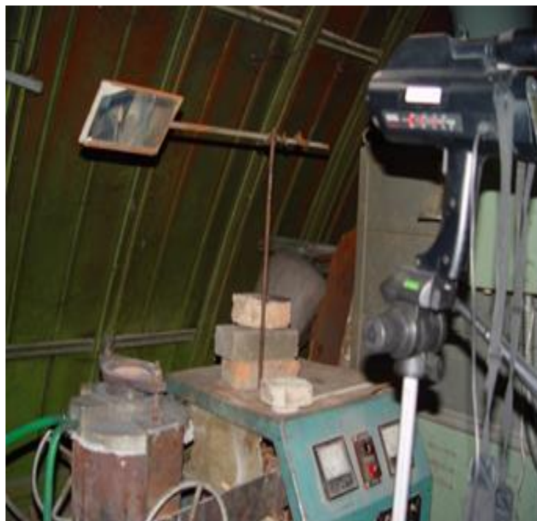
Сурет 2.7 – Үлгілердің отқа төзімділігін анықтайтын Тамман пеші
