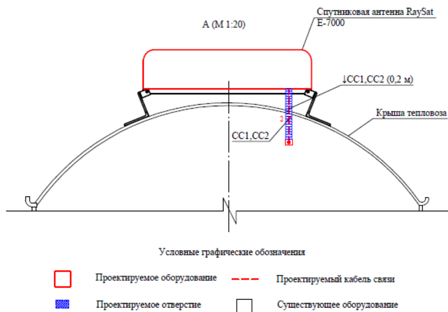
Рисунок 17 - Установка антенны RaySatER-7000 на крыше локомотива
