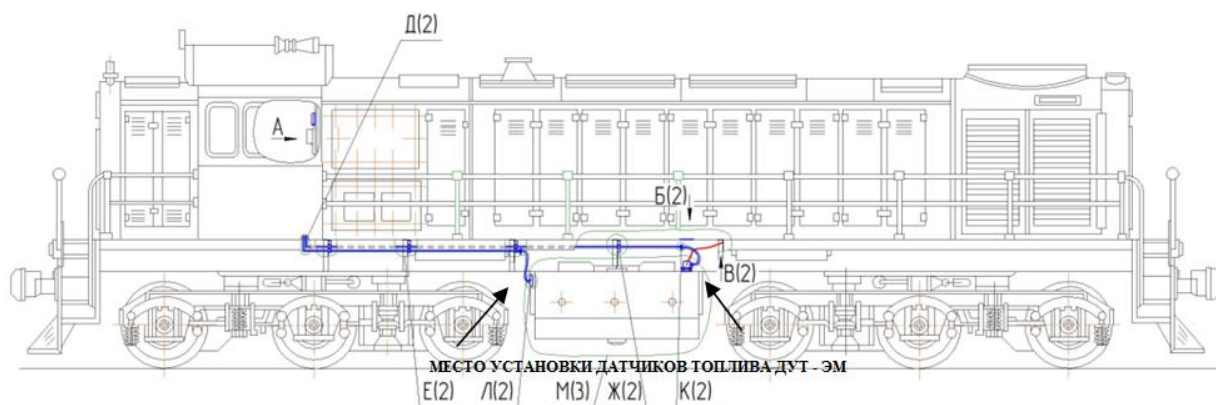
Рисунок 19 - Установка датчиков топлива ДУТ-ЭМ в топливном баке ТПС
