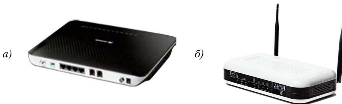
3.6 Сурет - ONT жабдықтарының пайда болуы: а) echolife hg8242 (huawei), ә) nte-rg-1402gc-w (eltex)
