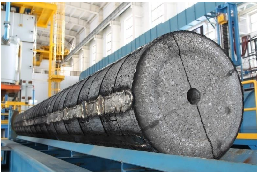
Рисунок 9 – Электрод, сваренный на установке плазменной сварки
