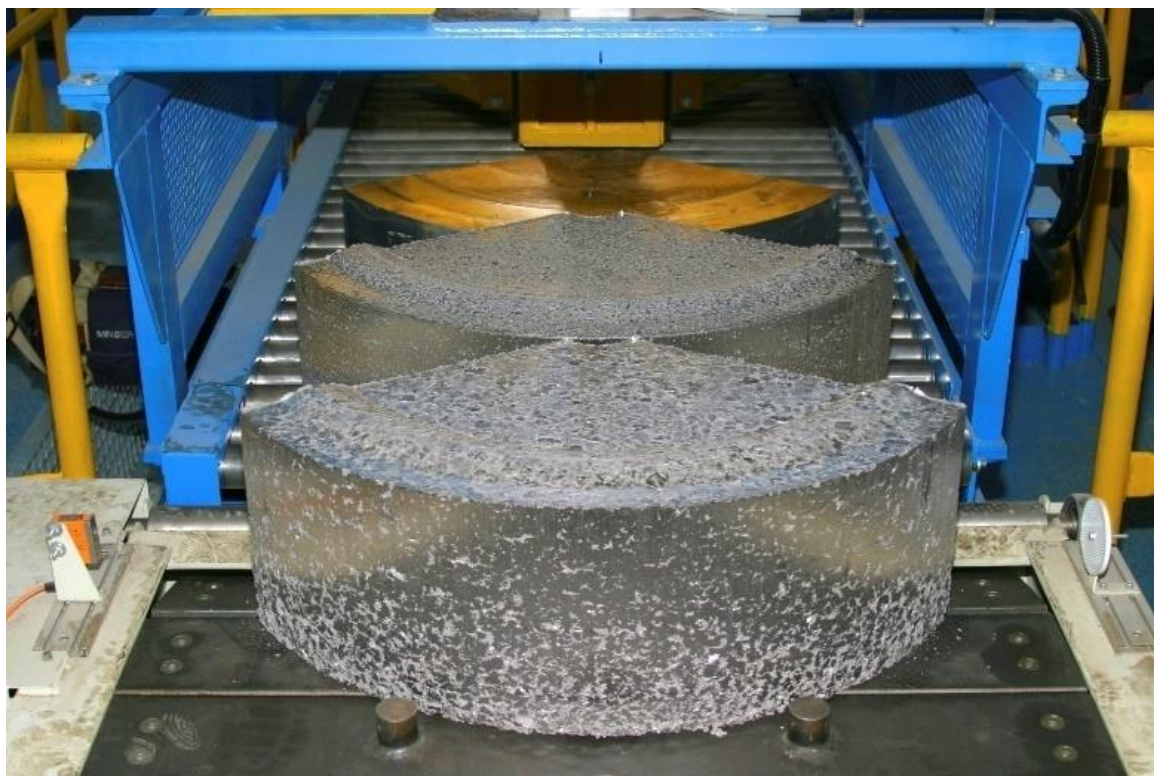
Рисунок 8– Готовые брикеты электрода
