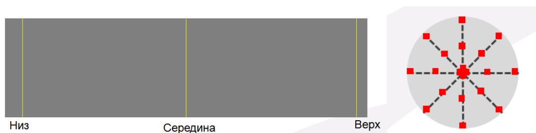
Рисунок 10 – Схема разделения экспериментальных сплавов на части
