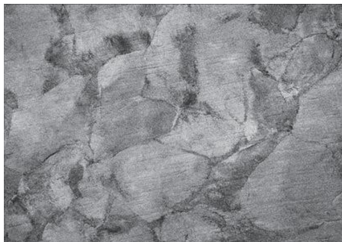
Рисунок 17 – Макроструктура сплава Ti-10V-2Fe-3Al обработки термической деформацией
