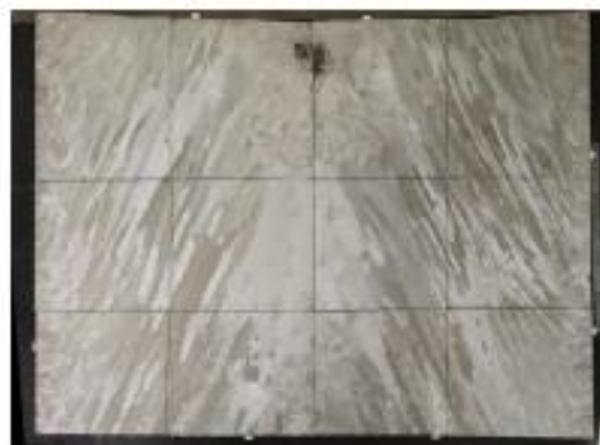
Рисунок 2 – Результаты макро-травления верхней части слитка
