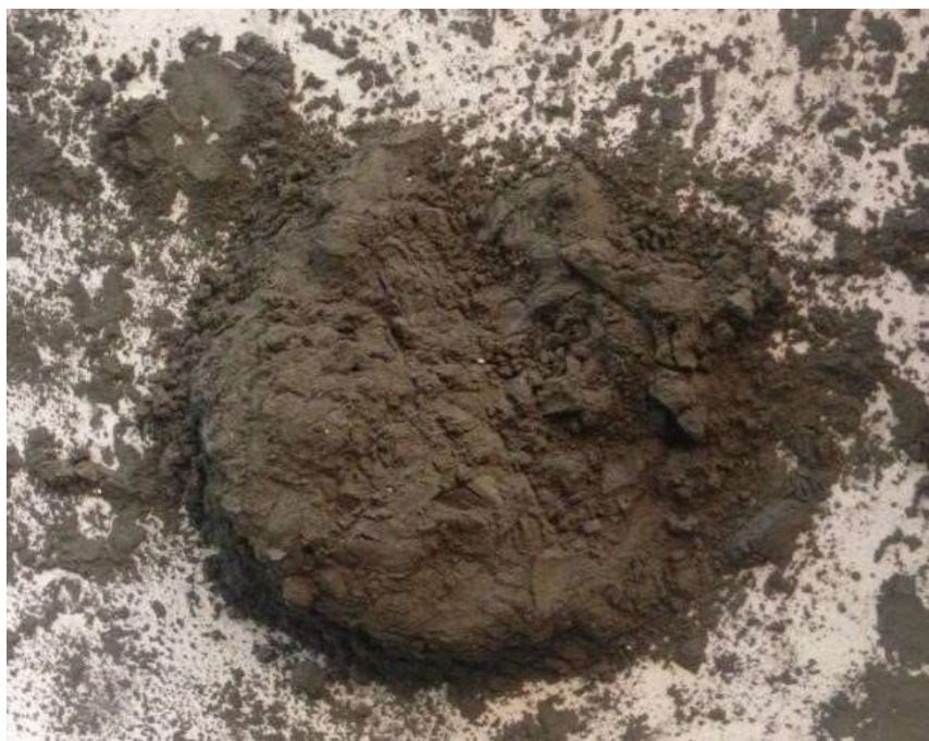
12 – сурет - Планетарлық диірмендегі МА-дан кейін Ti-Nb жүйесіндегі ұнтақ
