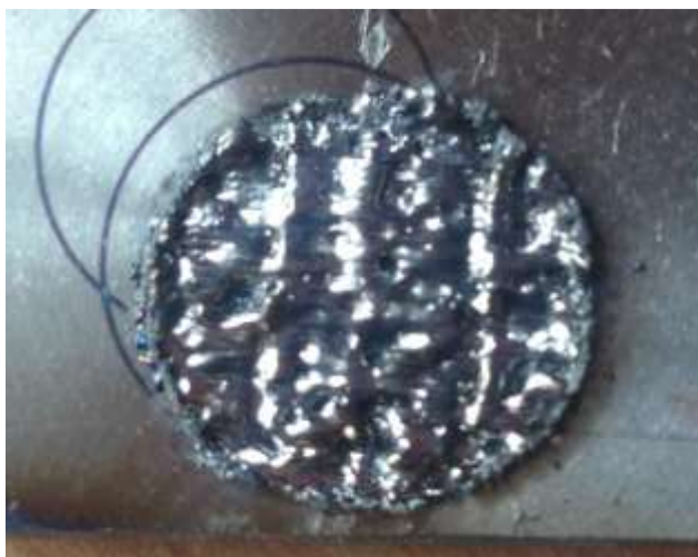
26 – сурет-SLM әдісімен алынған Ti-Nb қорытпасының көп қабатты үлгісі
