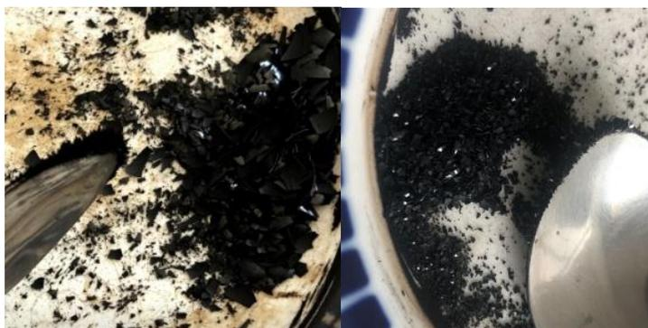
Рисунок 16 Полученный порошок магнетита
