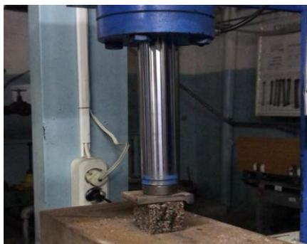
Рисунок 4 – Размещение нажимных пластинок и образцов на прессе
