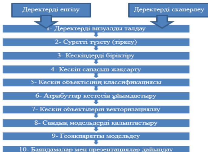
Сурет 1 - ГАЗ технологияларындағы қашықтықтан зондтау мәліметтерін өңдеудің сызбасы
