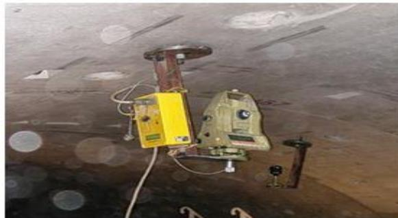
Сурет 5 - Роботталған электронды тахеометрлер:
