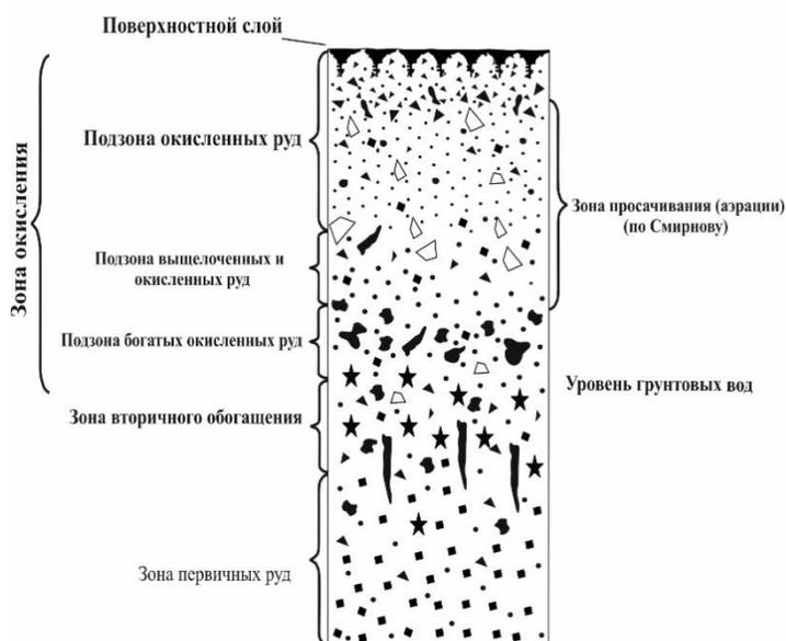
**Приповерхностная часть** - представляет собой поверхностный слой морфология которой распычато и повторяет таковые рудные зоны, мощность редко до первых метров. Состав - интенсивно дезинтигрированные породы остатков руд и вмещающих пород из которых могут быть полностью удалены даже самые трудноподвижные соединения. В случаях карбонатных вмещающих пород - интенсивно развита загнивание.
