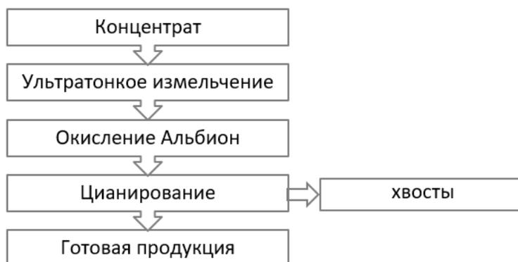
Рисунок 1 – Стандартная схема переработки упорных сульфидных золотосодержащих концентратов по технологии «Альбион»
