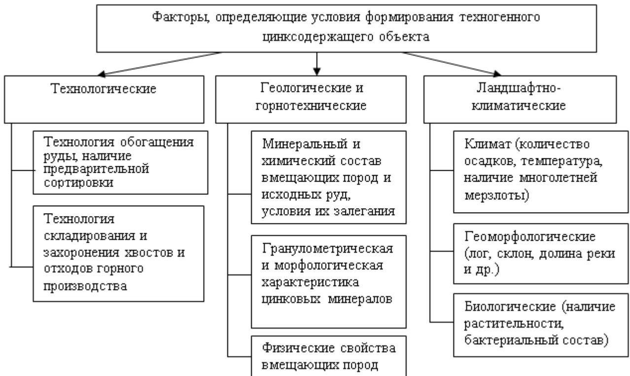
Рисунок 1–Факторы, определяющие условия формирования техногенного цинксодержащего ресурса
