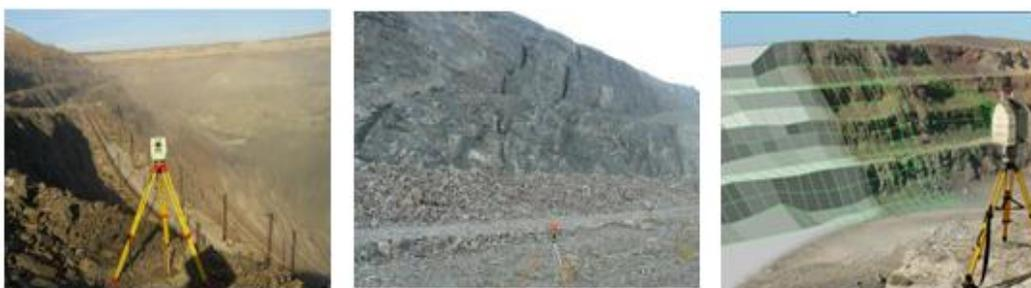
Сурет 4 - а) тахеометрмен бақылау; ә) беткей деформациясы; б) лазерлік сканирлеу
