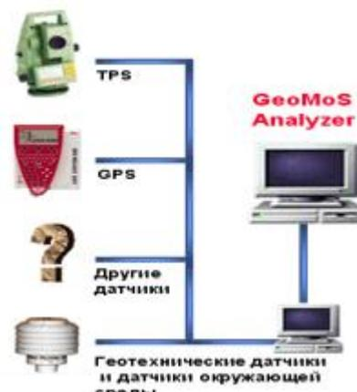
Рисунок 5 - а) принцип сбора данных системы GeoMoS
