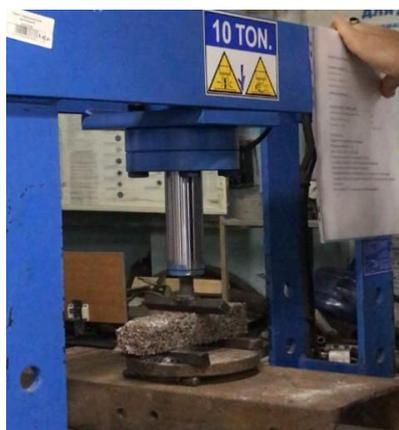
Рисунок 3 – Расположения образца на опорных элементах
