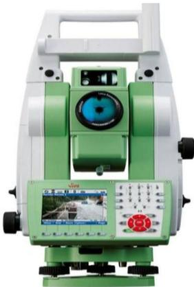
*Екінші типті электронды тахеометрлерге* орташа классты аспаптар жатады (Leica, Nikon, Trimble). Олар карьердегі геодезиялық тораптарды дамыту, жобадан жергілікті жерге көшіру өлшеулері, тура және кері геодезиялық қиылыстыру есептерін шешуде қолданылады, бұрыштық дәлдігі 1"-тан 5"-аралығында.
