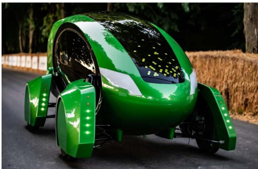
Рисунок 3 – Автономный электромобиль Kar-Go [3]
