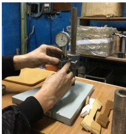
Рисунок 3 – Испытание на твердость по Шору
