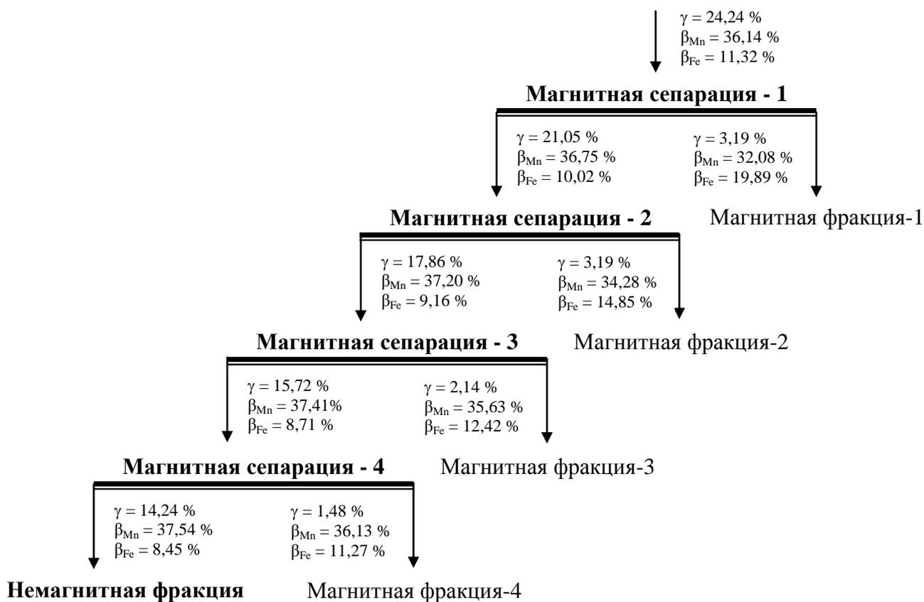
Рисунок 1 – Схема магнитного обогащения
