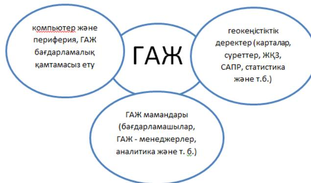
Сурет 1 – геоақпараттық жүйенің негізгі компоненттері
