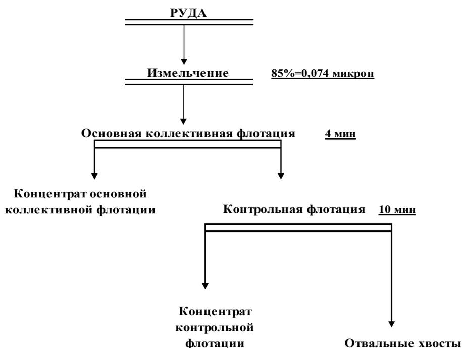
Рисунок 1 – Схема проведения тестовых флотационных испытаний в открытом цикле
