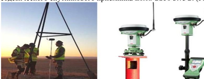
Рисунок 3 -- Определение координат пунктов GPS-приемниками
