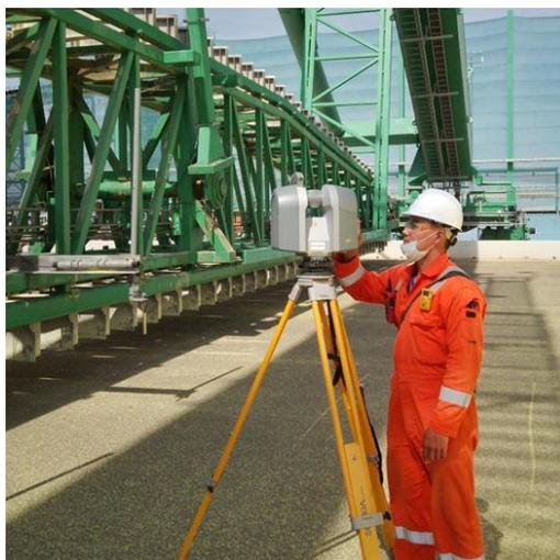
Сурет 1 -Құрылыс объектісінде Trimble TX8 лазерлік сканер көмегімен 3D моделін құру процесі
