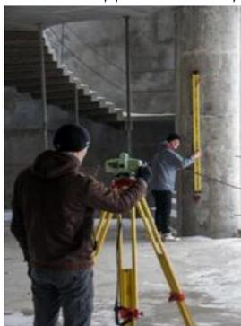
Рисунок 1 - Наблюдения за осадками методом геометрического нивелирования
