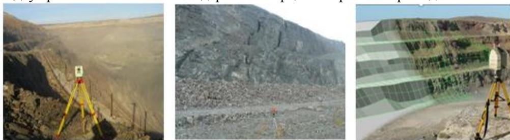
Сурет 4 - а-тахеометрмен бақылау; ә) беткей деформациясы; б)лазерлік сканерлеу
