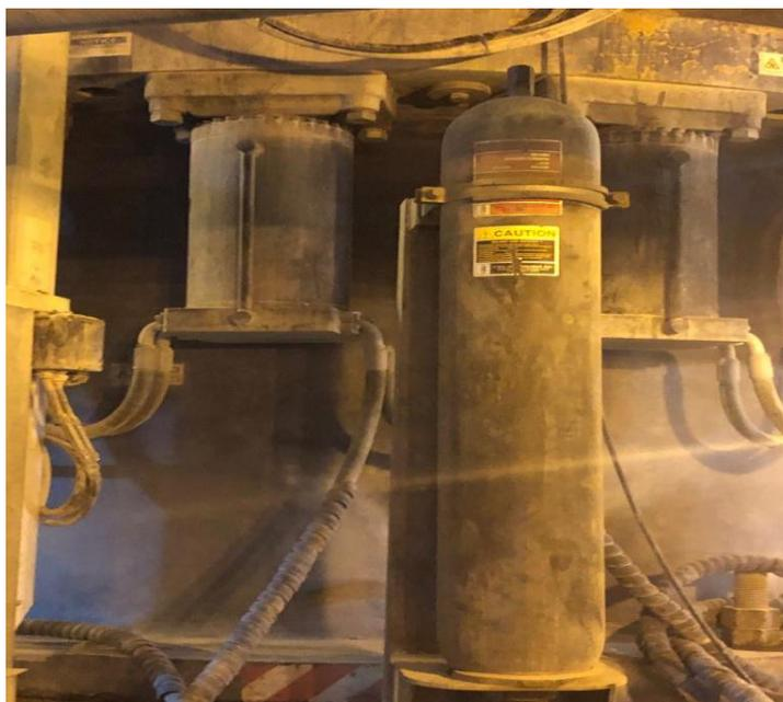
Сурет – 6. Гидравликалық аккумулятор (Ақтоғай 2021)
