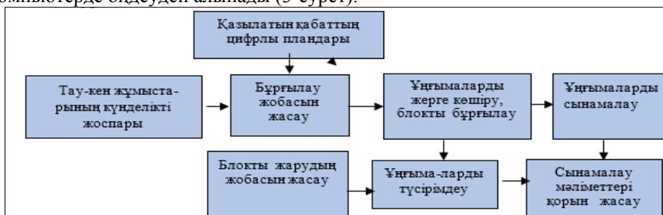
Сурет 3 - бұрғылау-жару жұмыстарын маркшейдерлік қамтамасыз етудің блок-схемасы
