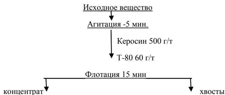
Рисунок 1 Схема флотации шунгита
