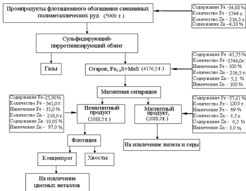
Рисунок 1 – Технологическая схема переработки хвостов обогащения полиметаллической руды
