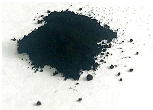
Рисунок 3 – Мелкодисперсная фракция железосодержащего кека выщелачивания железистых песков
