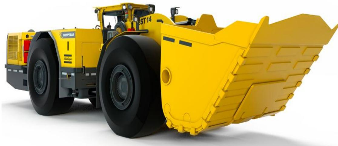
Рисунок 1 - Погрузочно-доставочная машина ST 14
