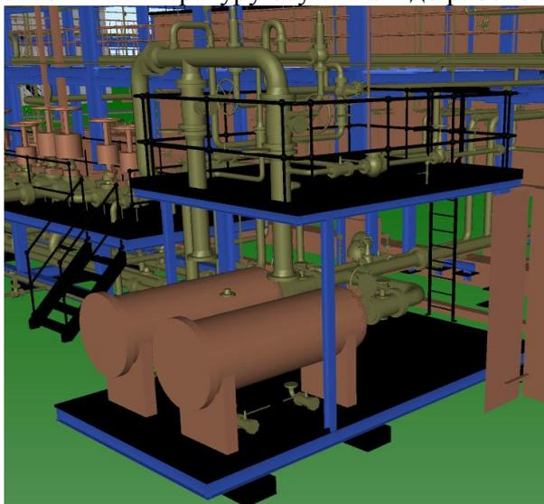
Рисунок 3 - Фильтр – сепаратор
