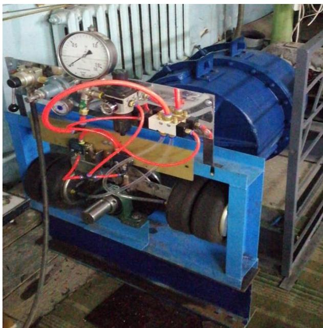
Рисунок 1 – Общий вид стенда для исследования возможностей пневмобаллонного вспомогательного привода
