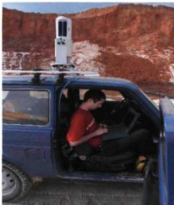
Рис. 20 – Производство съёмок сканером с использованием мобильного комплекса
