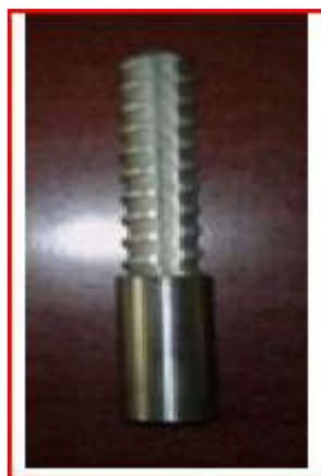
Рисунок 2.10 – Составной металлических анкер
