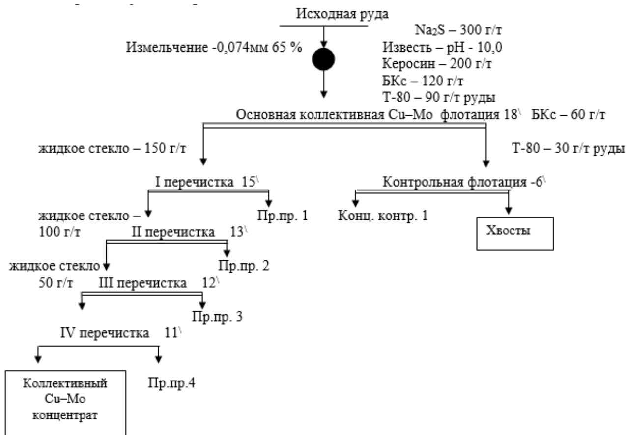
Рисунок 5 – Схема коллективной флотации медно-молибденовой руды
