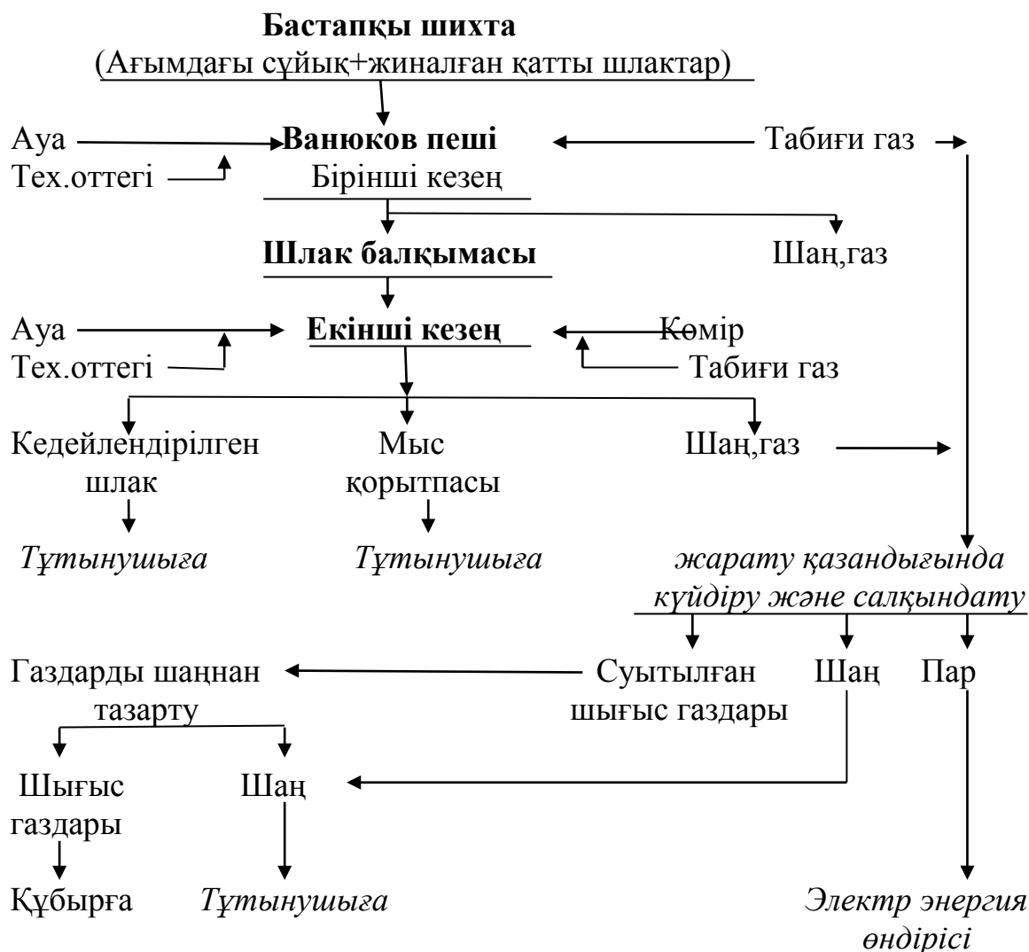
10 - сурет - Ванюков пешінде шлакты кешенді өндеудің негізгі технологиялық сызбасы
