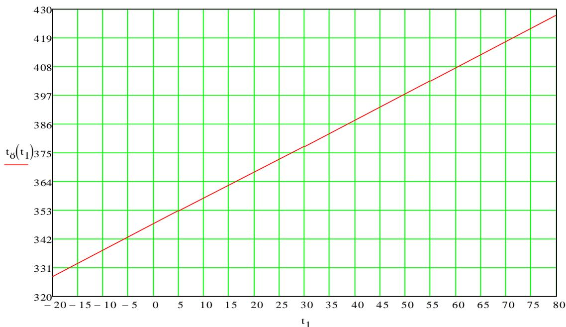
Рисунок 10 – Расчетная зависимость температуры цапфы трехшарошечного долота ( $t_{ц}$ ) от величины начальной температуры продувочного воздуха ( $t_1$ ).  $N=2500$  Вт;  $G=0,210$  кг/с;  $m=3$ ;  $t_1$  изменялся от  $-20^{\circ}\text{C}$  до  $80^{\circ}\text{C}$
