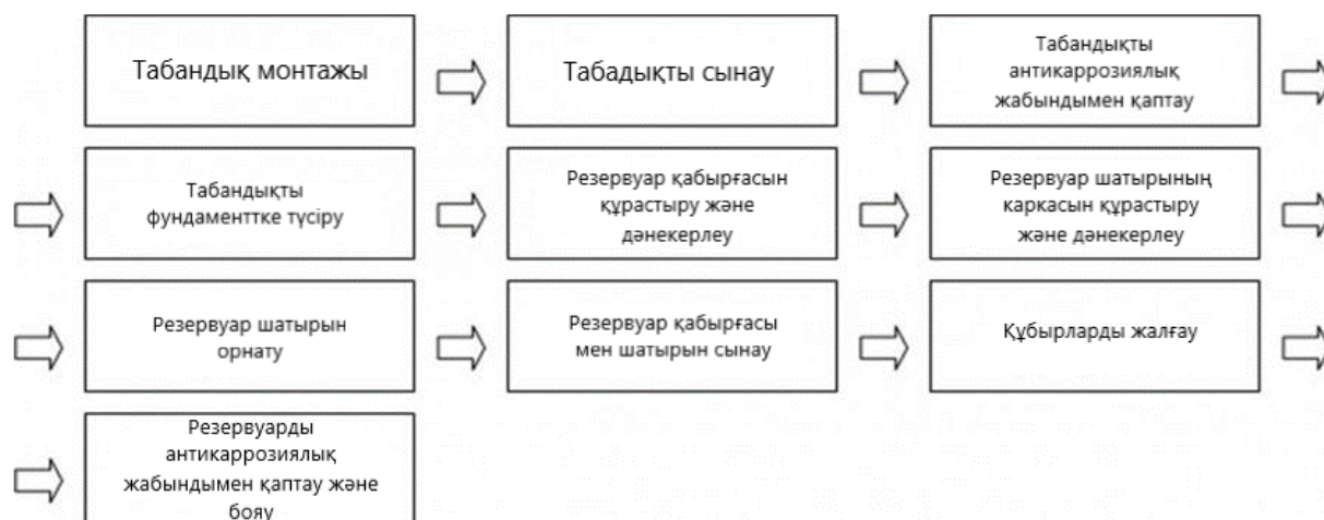
3-сурет. Монтаждау жұмыстарының реттілігі
