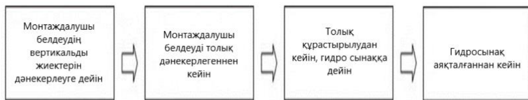
8-сурет. Резервуар қабырғасының вертикальды ауытқуын бақылау кезеңдері
