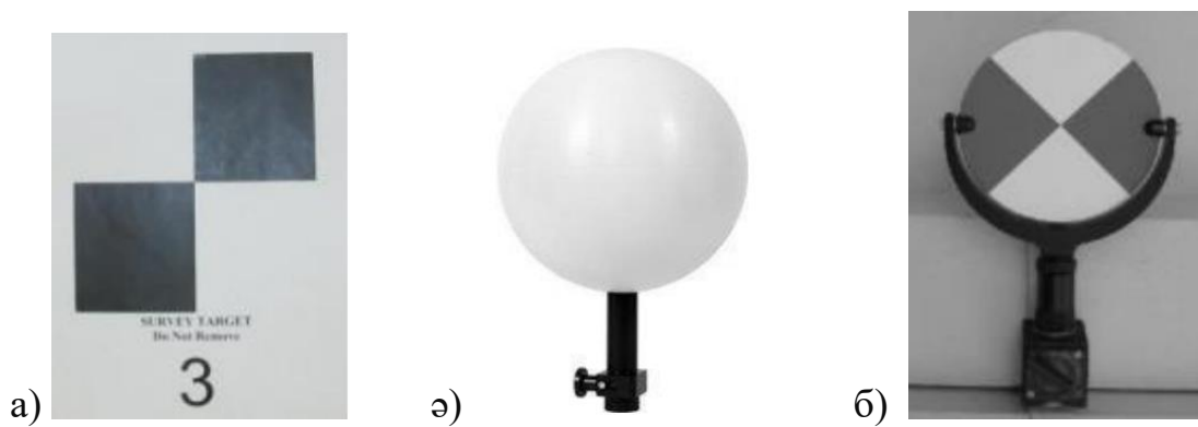
13-сурет. Марка түрлері а) тегіс жабысқақ ә) сфералық б) айналмалы
