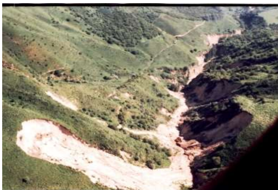
Рис 4.4 Малютинский лог, очаг ливневого селеобразования, по всей длине ручья проявления оползней, интенсивно протекают процессы боковой и донной эрозии
