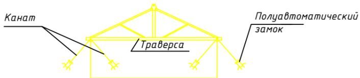
Двухветвевой строп и кольцевой строп для монтажа прогонов
