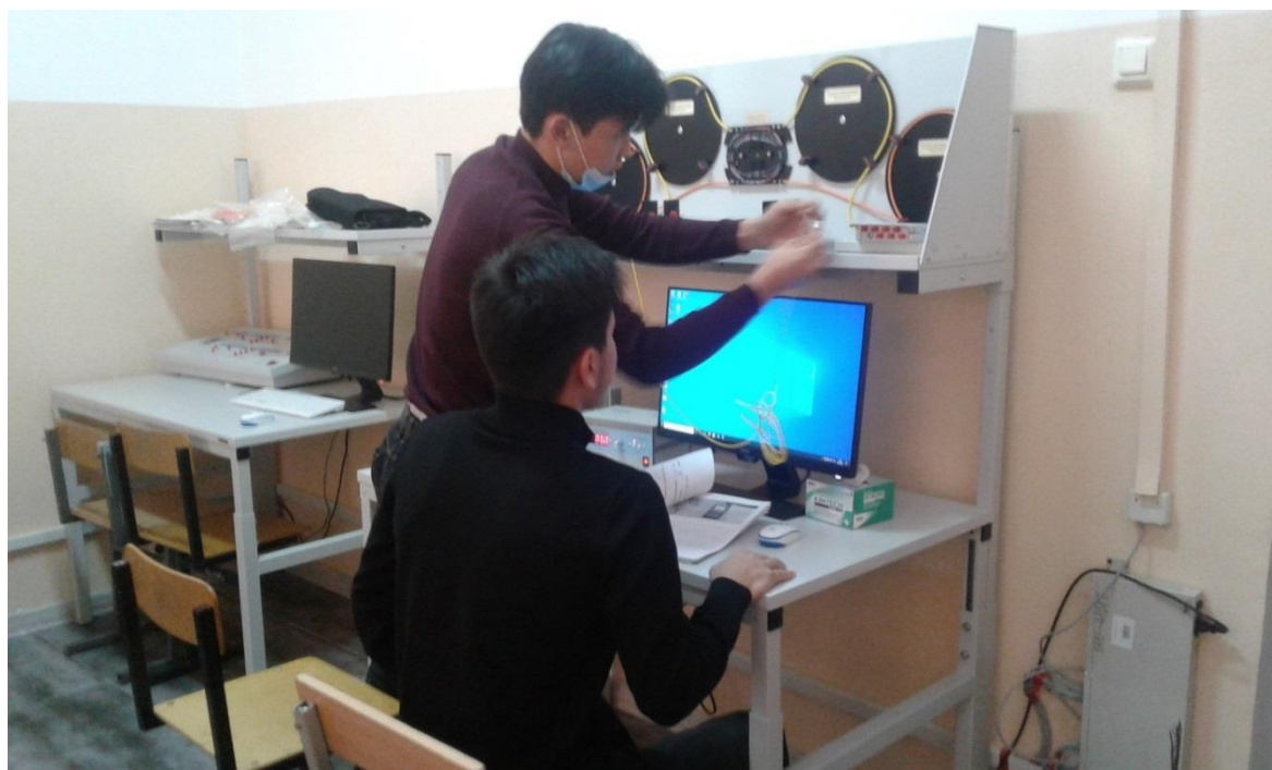
Рисунок 8. Учебная лабораторная установка «Измерение параметров оптической линии связи»
