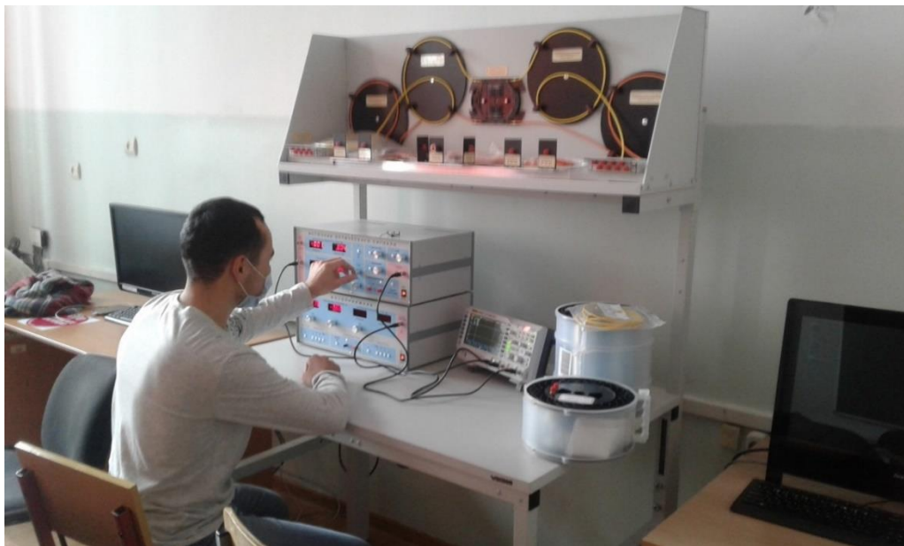
Рисунок 11. Учебная лабораторная установка «Модель оптического линейного тракта»
