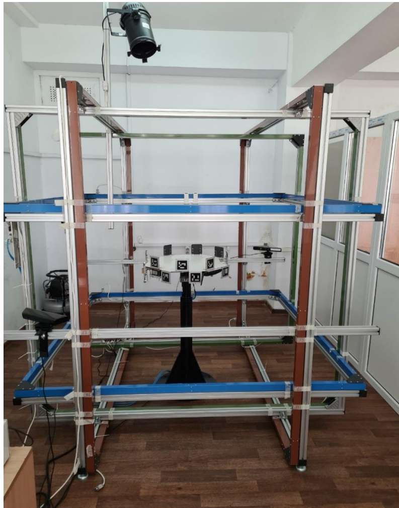
Рисунок 5. Стенд имитации относительного движения и отработки систем ориентации и стабилизации наноспутников SX-025
