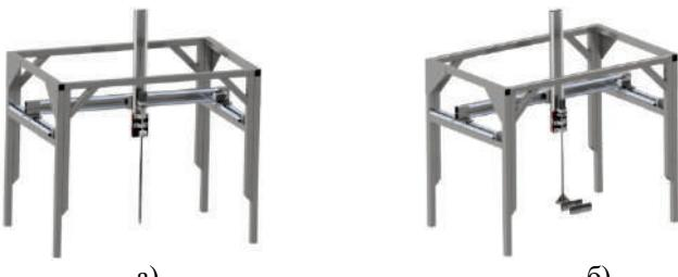
Рисунок 3 - 3D модели конструкции с: а) пробоотборником,
