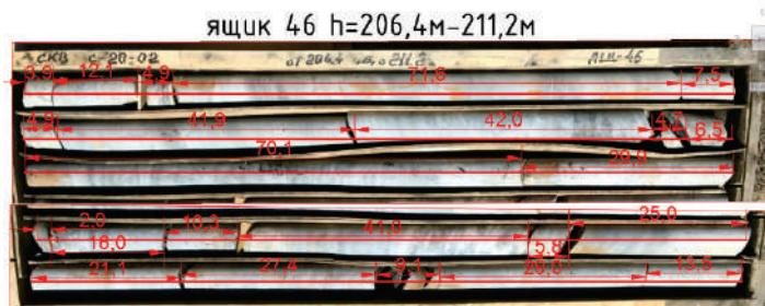
Рисунок 1 - Определение размеров структурных блоков по глубине пробуренной скважины С-20-02
