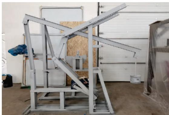
Рисунок 3 – Экспериментальный образец шестизвездного прямолинейно-направляющего преобразующего механизма привода
