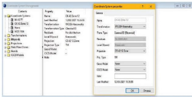
Рисунок 2 Создание системы координат в Leica Geo Office
