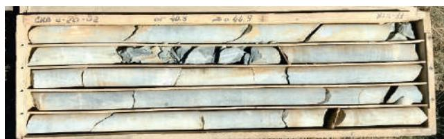
Рисунок 2 – Керны по геологической скважине С-20-02, подготовленные к транспортировке и отправке в лабораторию
