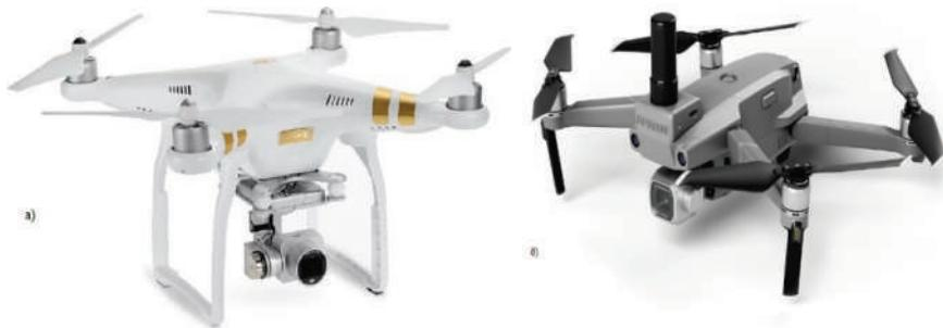
Рисунок 1 – а) DJI Phantom 3 SE, б) DJI Mavic 2 Pro с PPK
