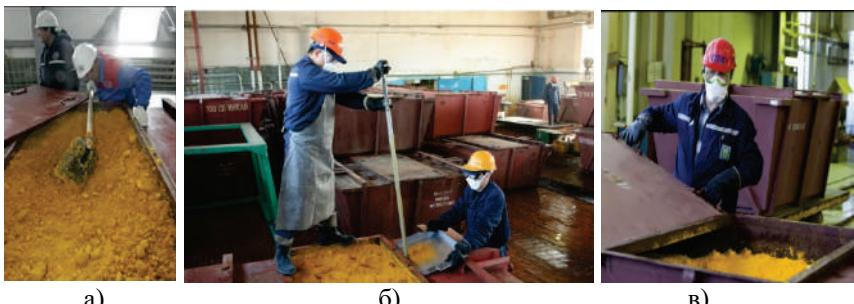
Рисунок 1 - Операции, проводимые вручную: а) разравнивания «желтого кека», б) взятия пробы, в) снятия крышки ТУК-118
