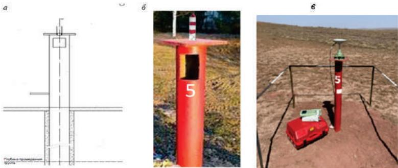
Рис.3 - а) конструкция, б) внешний вид ППЦ, в) ведение мониторинга
