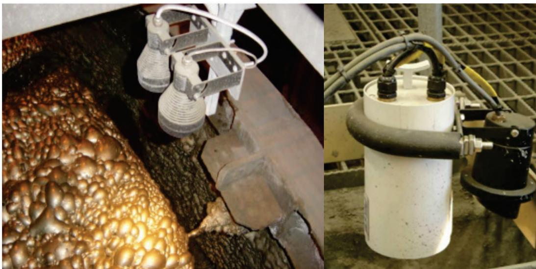
Рисунок 1 – Система VisioFroth™ установленная на индивидуальной флотомашине
