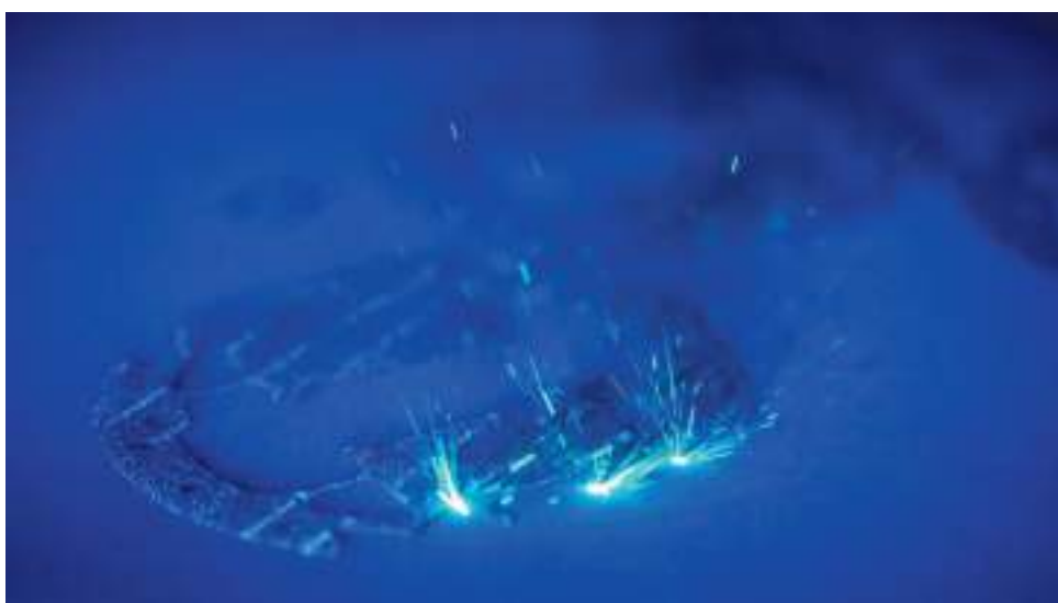
Сурет-2 – Металды лазерлік балкыту процесі
