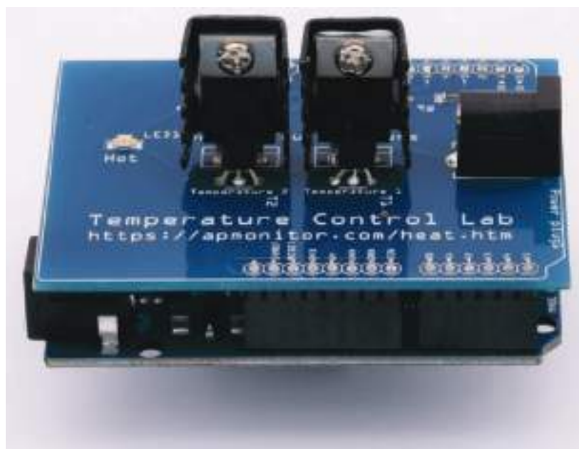
Рисунок 1 – Мини лаборатория TCLab
