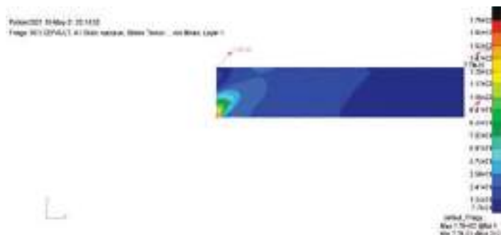
12-сурет – 45° бұрышта қабаттардың бағдарлануының кернеу изолиниялары
