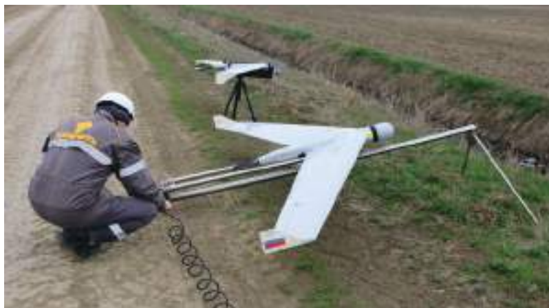
Рисунок 3. Иллюстрация запуска БПЛА самолетного типа[5]
