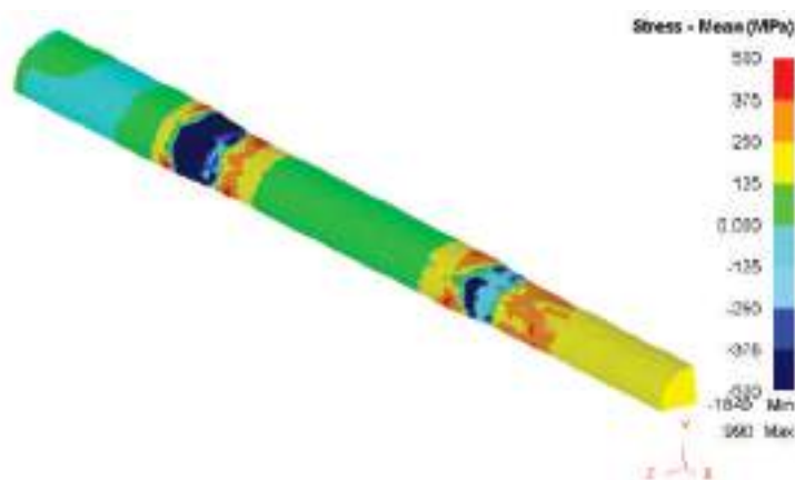
Рисунок 11 - Среднее гидростатическое давление по схеме цехового волочения
