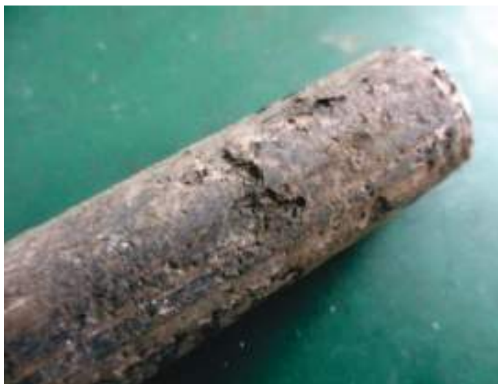
Рисунок 5 – Коррозионное разрушение компонентов скважинного штангового насоса
