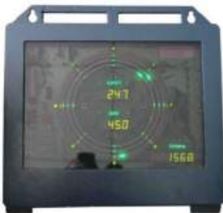
3-сурет. Корветте телеметриялық жүйе операторының дисплейі: ұңғыманың азимуттық бұрышының ағымдағы мәндері көрсетілген - 247°, ұңғыманың зениттік бұрышы - 45° және ұңғыманың тереңдігі - 1568 м
