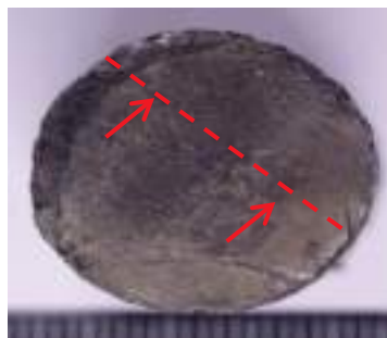
Рисунок 4 – Сечение шлифа в области излома насосной штанги после эксплуатации в скв. №59
