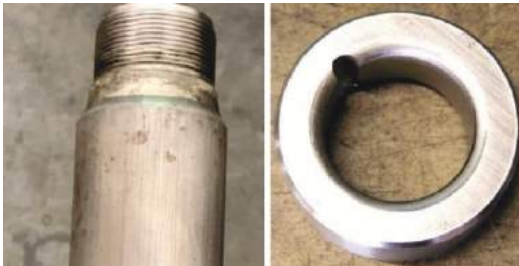
Рисунок 4 – Повреждение поверхности плунжера и шарового седла клапана
