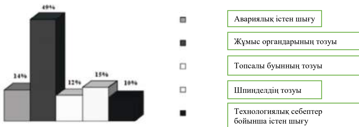
2 – сурет. Бұрандалы түптік жетектің істен шығу себептерінің диаграммасы
