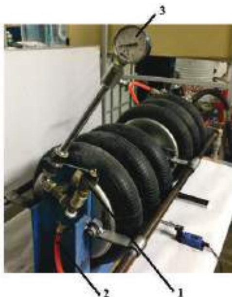
1 – предохранительный клапан; 2 – рукав для поддержания давления сопротивления; 3 – манометр. Рисунок 3 – Общий вид системы обеспечения параметров сопротивления (давления).
