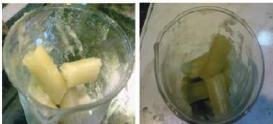
Рисунок 2 – Образцы мягких восковых отложений при повышении температуры до точки помутнения
