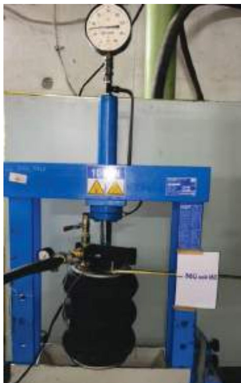
Рисунок 7 – Схема расположения сильфона в рабочей зоне пресса.
