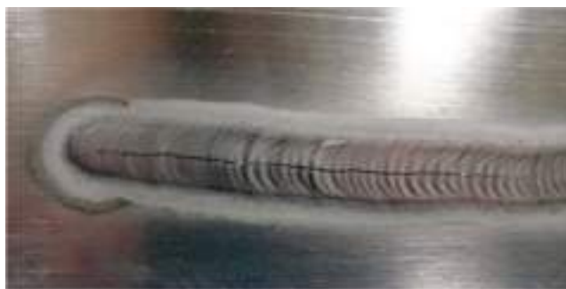
Сурет 3 – Жарықшақ түріндегі ақау
