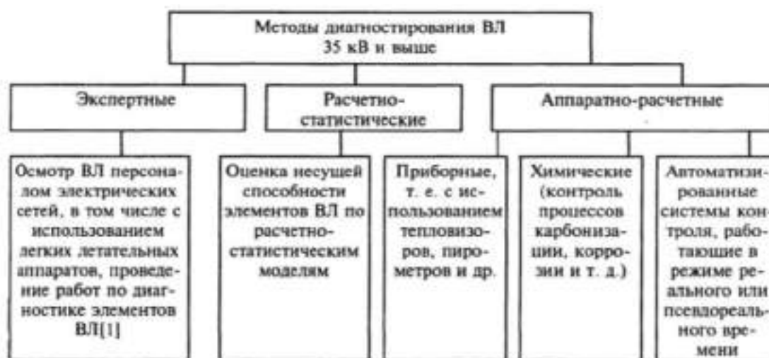
Рисунок 1. Структурная схема методов технического диагностирования ВЛ 35 кВ и выше[1]
