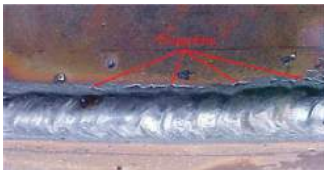
Сурет 4 – Дәнекерлеу тігісіндегі сызаттар
