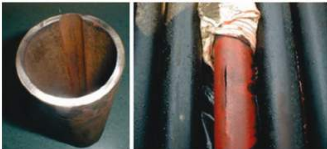
Рисунок 3 – Поломка трубопровода от трения
