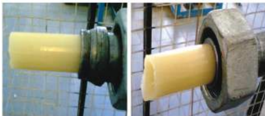
Рисунок 3 – Изображение отложений твердого парафина в трубопроводе при увеличении расхода при низкой температуре 40°C
