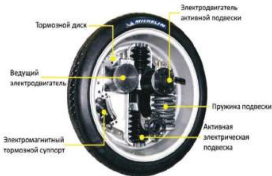
Рис. 1. Система рекуперация колеса электромобиля.
