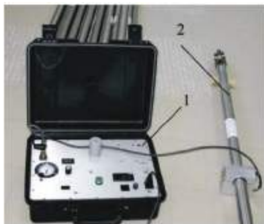
1 - жерүсті жабдықтары; 2 - телеметриялық ұңғыма зонды. 2-сурет. «Корвет» ұңғымалық телеметриялық жүйесі
