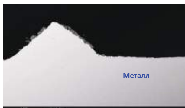
Рисунок 6 – Вид вторичных трещин в области излома насосной штанги после эксплуатации в скв. №59
