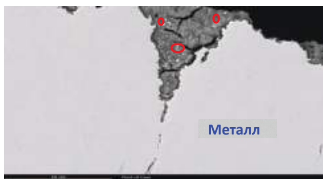
Рисунок 7 – Вид вторичных трещин в области излома насосной штанги после эксплуатации в скв. №59
