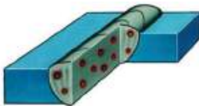
Сурет 7 – Дәнекерленген тігістегі кеуектер.
