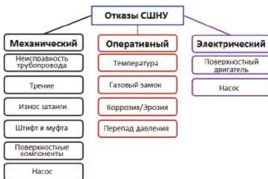
Рисунок 2 – Основные неисправности ШСНУ
