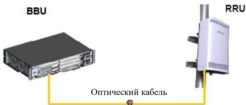
Рисунок 2.2 – Базовая станция «Huawei DBS3900»
