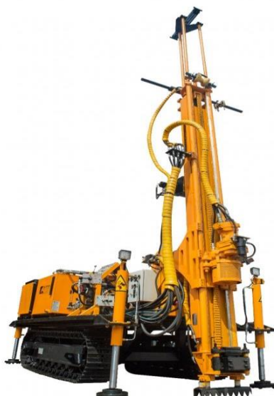
Рисунок 5. Буровая установка SDS 900
