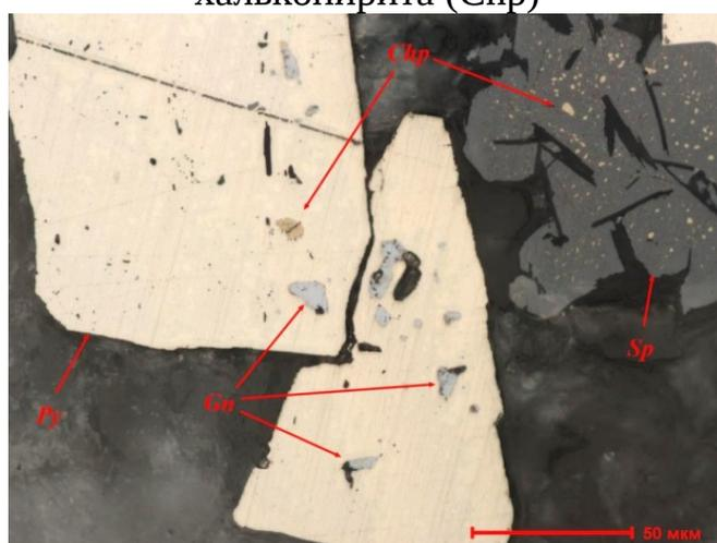
Рисунок 4.24 - Аншлиф. Зерно пирита (Py) в сростке со сфалеритом (Sp). В пирите включения галенита (Gn) и халькопирита. В сфалерите эмульсионная вкрапленность халькопирита (Chp)
