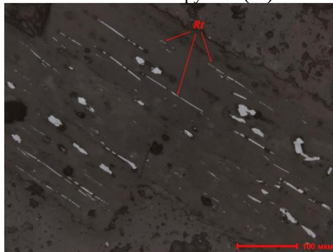
Рисунок 4.71 - Аншлиф. Зерна рутила (Rt), развитые по спайности слюдястых минералов
