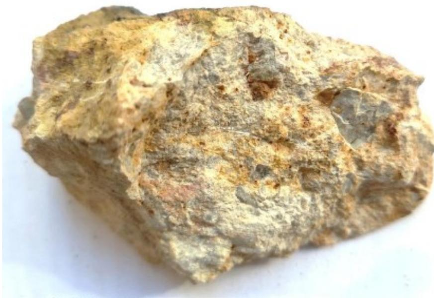
Рисунок 3.1 - Образец №1. Измененный ожелезненный витро-кристалло-литокластический туф
