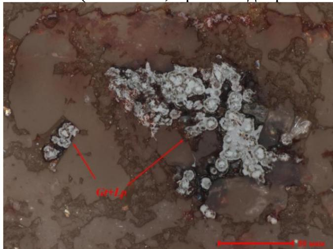
Рисунок 4.54 - Аншлиф. Скопления глобулярных зерен гидроокислов железа (Gt – гетит, Lp - лепидокрокит)
