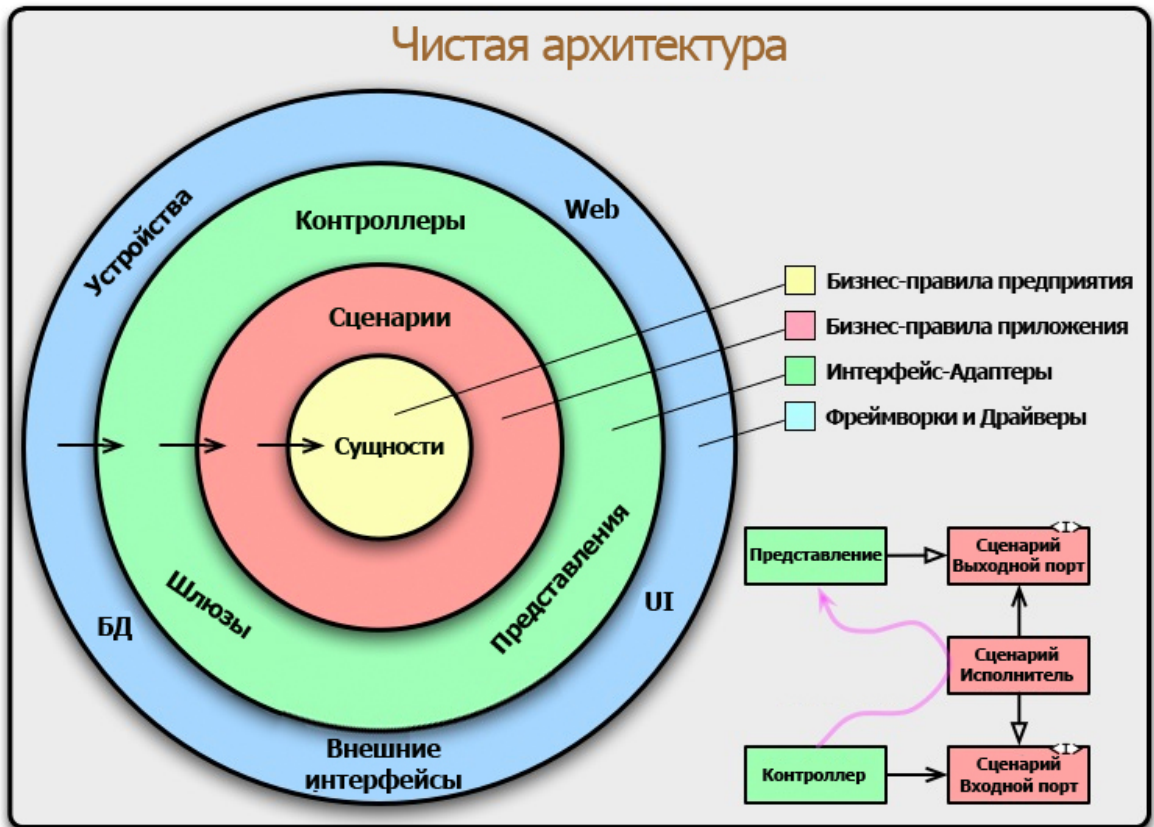
Рисунок 3.1 - Схема построения чистой архитектуры
