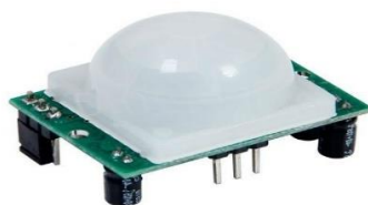
2. 10 - сурет HC-SR501 датчигінің суреті
