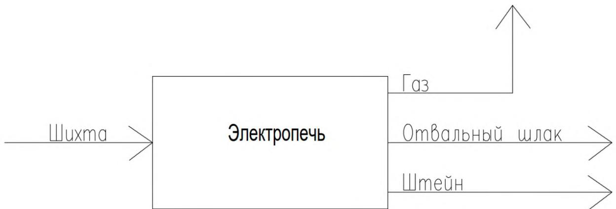
Рисунок 2.1 – Функциональная схема системы управления шестиэлектродная руднотермическая электропечь
