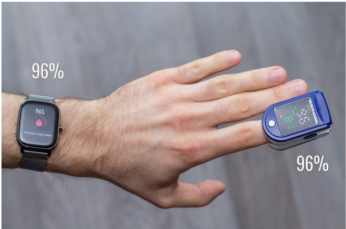
Сурет 1.7 – Импульстік оксиметрлердің екі түрінің дәлдігін салыстыру (ақылды сағат және классикалық)
