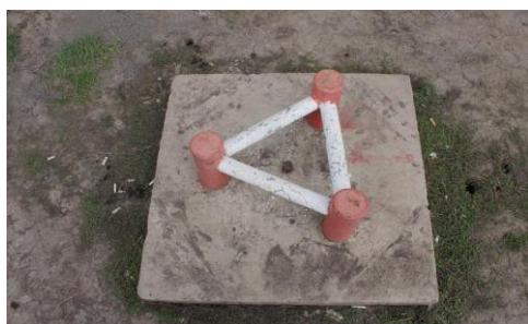
Сурет.3 - ғимарат бағаналарындағы мониторингтік нивелирлік нүктелер
