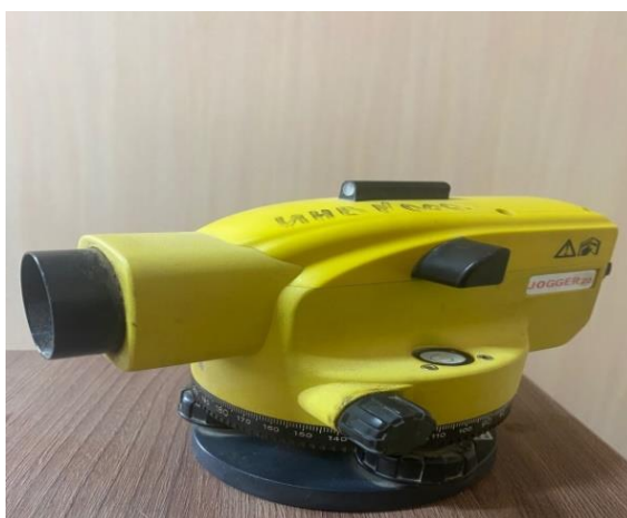
5 Сурет - Leica JOGGER20 – оптикалық нивелир
