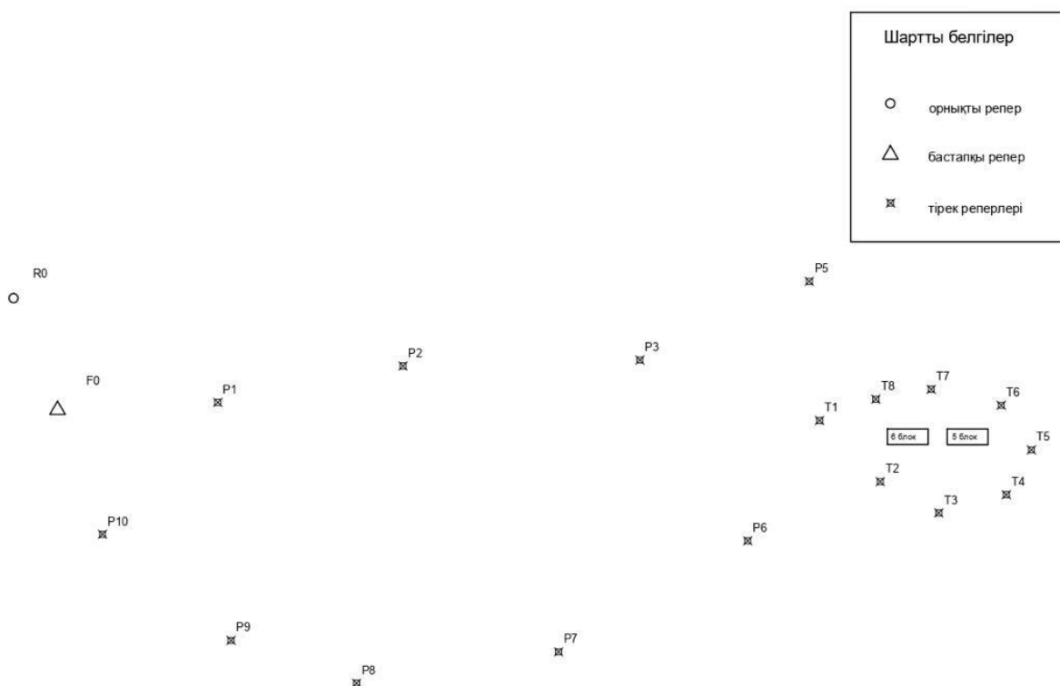
7 Сурет - Триангуляциялық геодезия негіздеме пункттерінің схемасы
