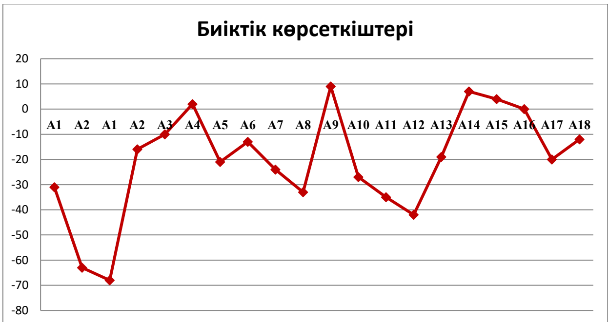
14 Сурет - Жаңа жергілікті координаттар жүйесіндегі деформациялық марканың ығысу траекториясы мен бағытын графикалық бейнелеу
