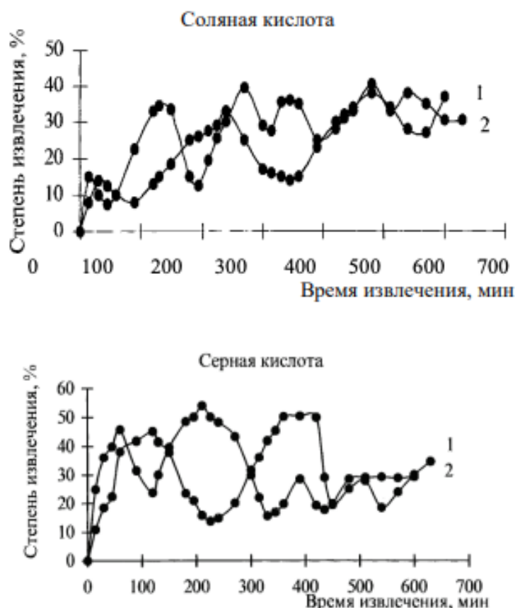
Рисунок 2 - Зависимость степени извлечения (%) от времени извлечения (мин.) Кривая 1- концентрация 1 моль/л соляной, серной и азотной кислот; Кривая 2- концентрация 3 моль/л соляной, серной и азотной кислот.
