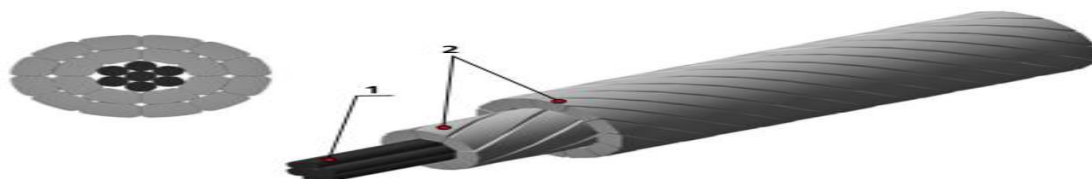
Рисунок 3.5 – Конструкция провода марки АСк2у: 1 – сердечник из высокопрочных стальных проволок, 2 – повивы из алюминиевых проволок
