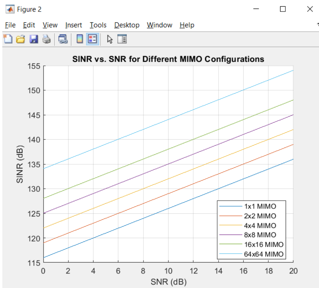
Рисунок 3.6 - График зависимости SINR (отношение сигнал/интерференция/шум) против SNR (отношение сигнал/шум) для различных MIMO-конфигураций.
