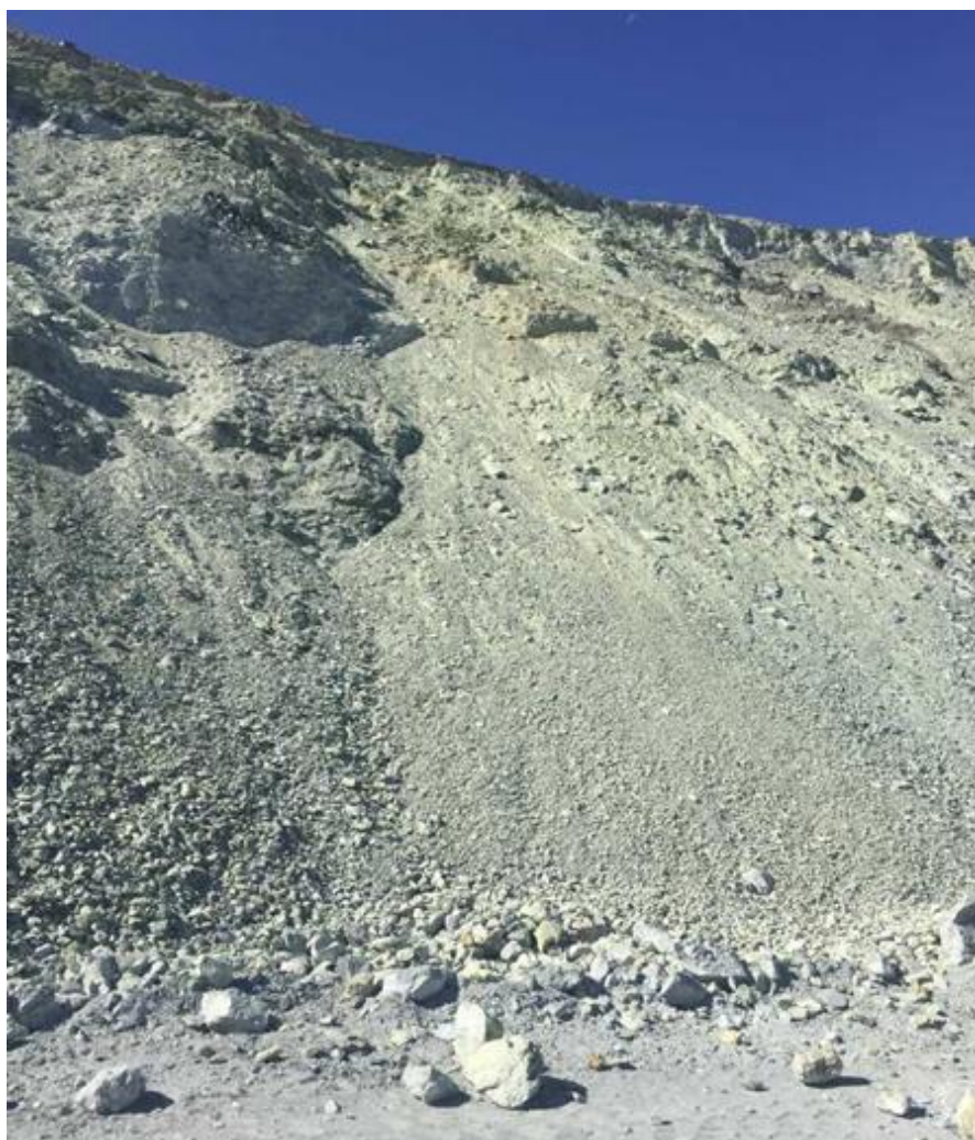
Рисунок 1.5.1 – Обрушения серпентинитов на гор. + 340 м ЮЗ борта
