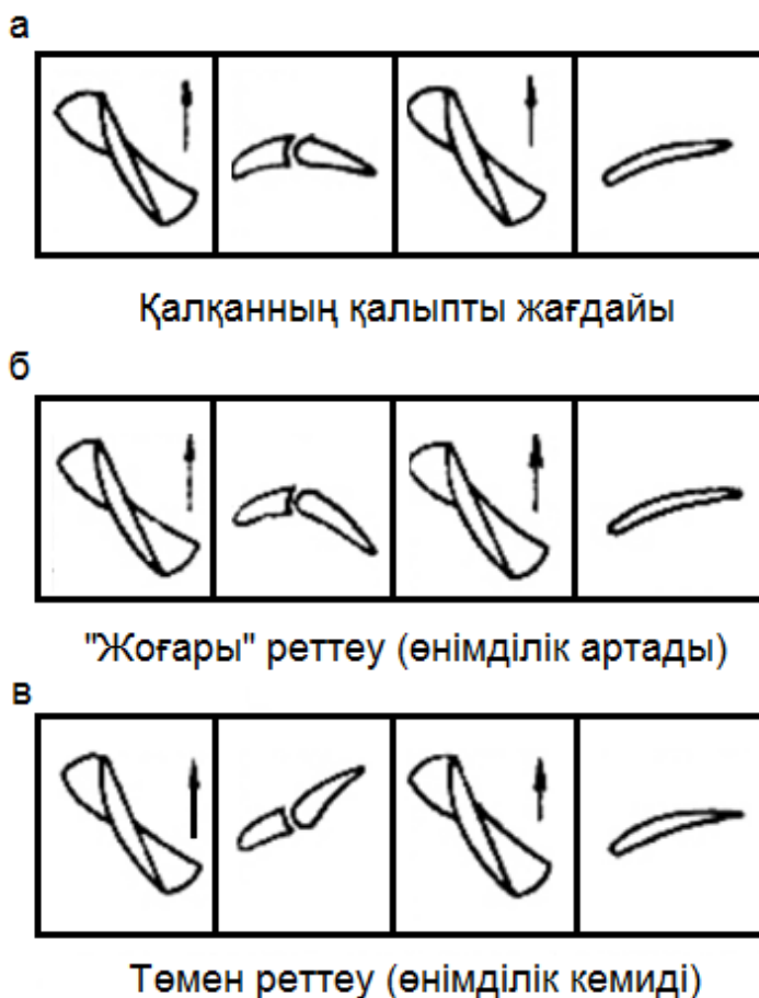
1.10 - сурет – Бағыттауыш қалақшалардың клапандарының көмегімен осьтік желдеткішті реттеу
