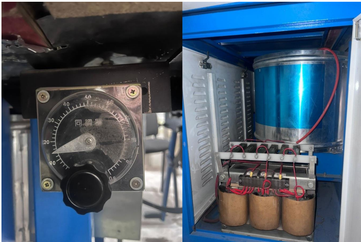
Рисунок 33 – Составные части и регулировка подаваемого тока
