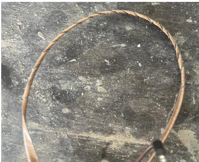
Рисунок 44 – Трос обмотанный тефлоном с нихромовой нитью
