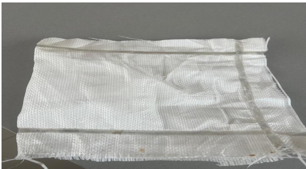
Рисунок 55 – Результат запаивания мешка с трех сторон
