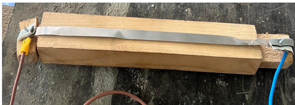
Рисунок 45 - Нихромовая лента закрепленная на брус с подключением проводов
