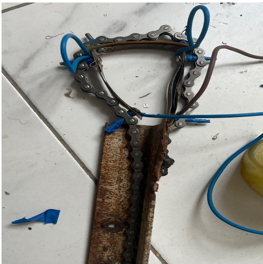
Рисунок 34 – Система для нагрева пучка мешка
