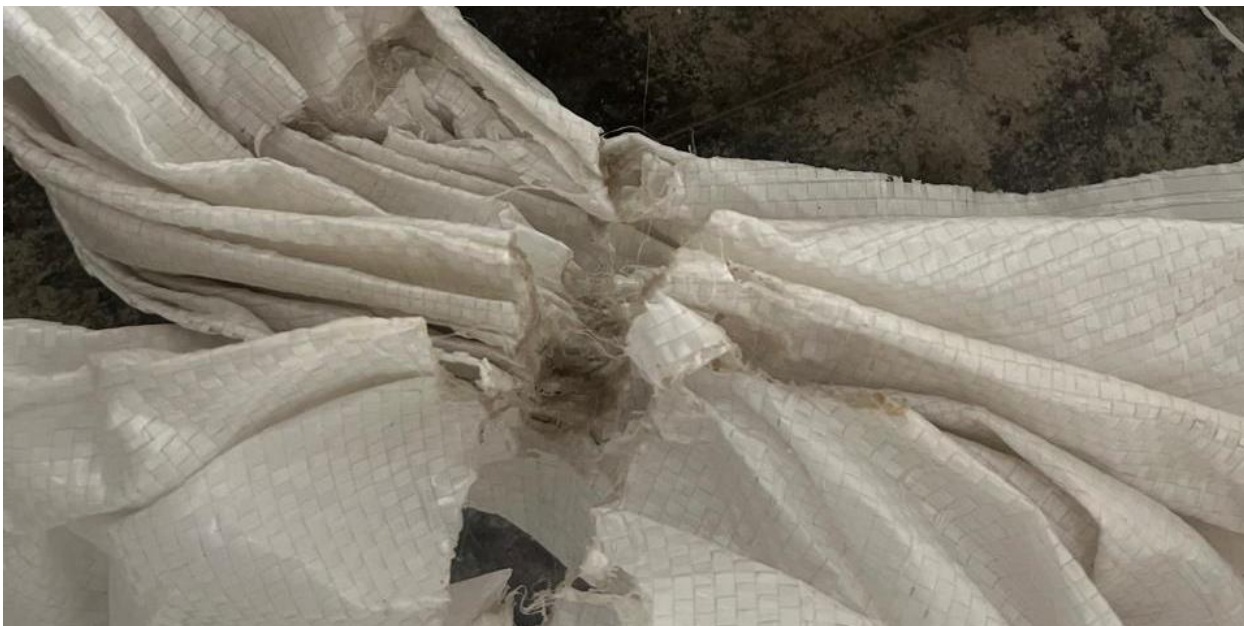
Рисунок 36 – Неудачная пайка пучка мешка
