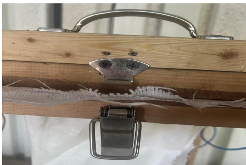
Рисунок 46 - Металлическая защелка для обеспечения равномерного давления
