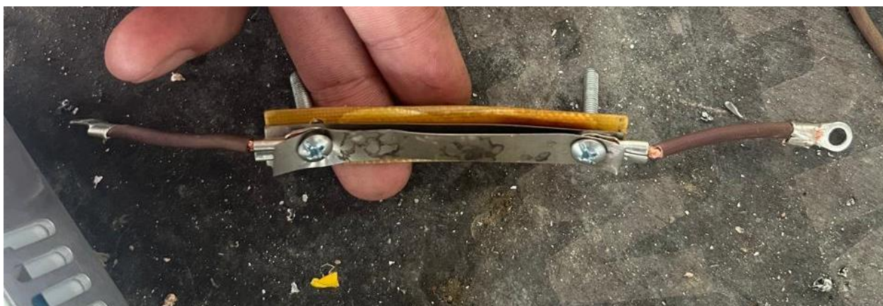
Рисунок 32 – Нихромовая пластина с стеклотекстолитом
