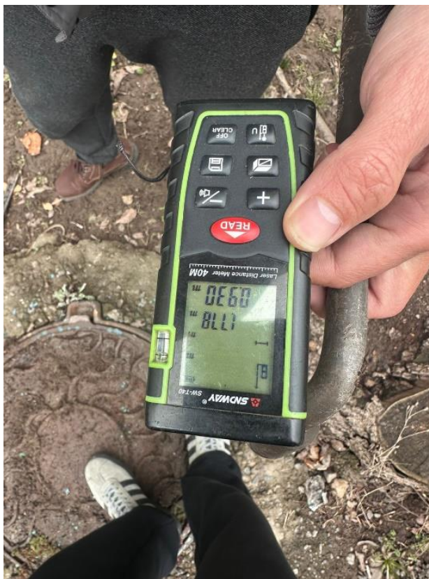
2.3-сурет – GNSS қабылдағыш және лазерлік қашықтық өлшеуіш (дальномер) көмегімен инженерлік құдықтың координаттары мен орналасуын анықтау
