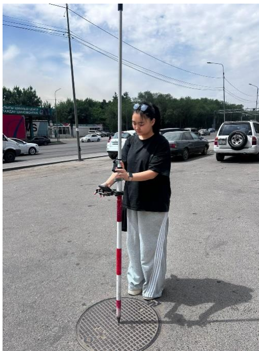
2.2-сурет – GNSS қабылдағыш көмегімен жергілікті координат нүктесін анықтау (Алматы қаласы, Медеу ауданы)
