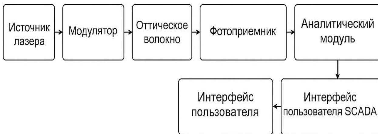
Рисунок 4.2 – Принцип работы распределённой волоконно-оптической DFOS системы
