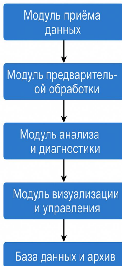
Рисунок 4.3 – Архитектура аналитического сервера распределённой волоконно-оптической системы
