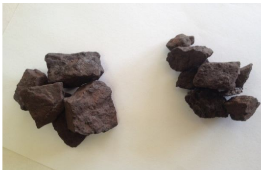
Рис. 3. Тяжелая фракция отсадки класса 10-40 мм. Марганцевые минералы: жианшуиит, вернадит, ориентит
