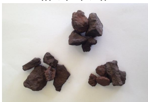
Рис. 6. Промпродукт 2 отсадки класса 10 -40 мм. Марганцевые минералы: жианшуиит, вернадит, пиролюзит, ориентит.
