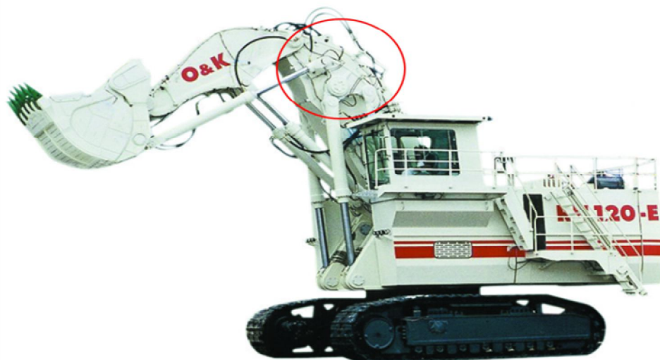
Рис. 7. Прямая лопата с кинематикой "Tri Power"
