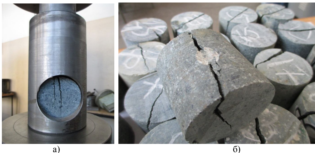
Рис. 6. Разрушение породы цилиндрической формы под воздействием стального шара: а – схема нагружения, б-разрушенные образцы.
