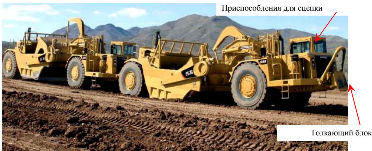
Рис. 9. Скреперы сцепленные один за другим при заполнении ковшей
