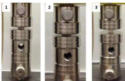
Рис. 12. Поведение композитного гидрогеля ПААГ-SiO 2 (10%) при сжатии (1,2) и после снятие нагрузки (3).
