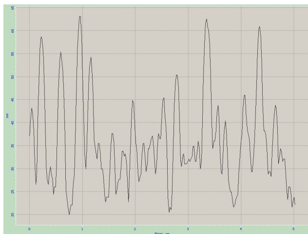
Рис. 7. Профиль поверхности углеродной пленки на подложке нержавеющей стали
