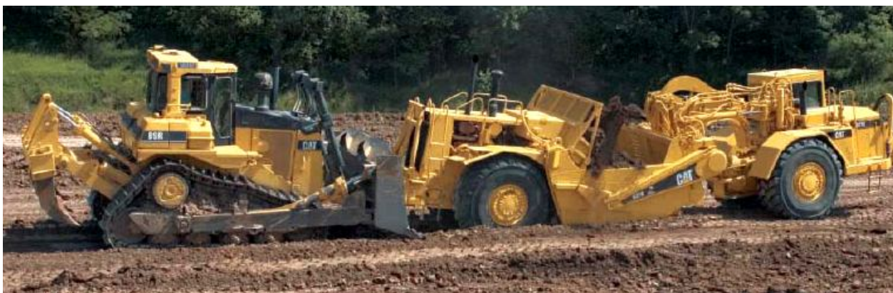
Рис. 7. Скрепер работающий с бульдозером-толкателем действующим на задний толкающий блок скрепера
