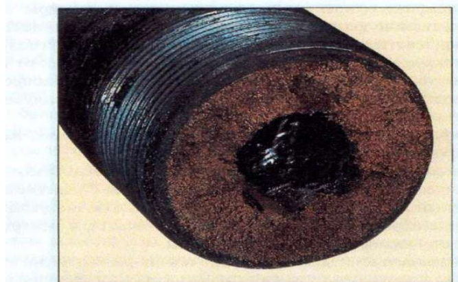
Рис. 3. Асфальто-смолопарафиновые отложения в НКТ
