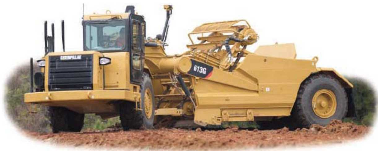
Рис. 1. Самоходный одномоторный скрепер вместимостью ковша 8,4 м 3
