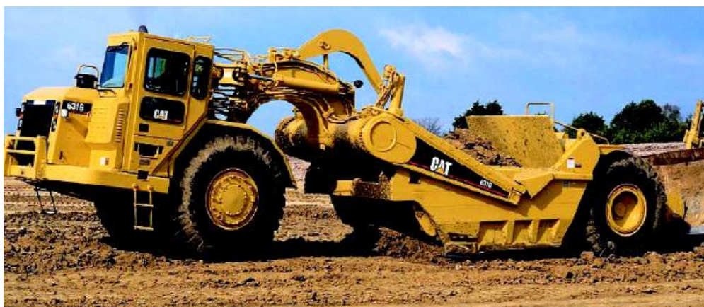
Рис. 11. Скрепер с одним двигателем, выемка от опускания ковша и перемещения скрепера
