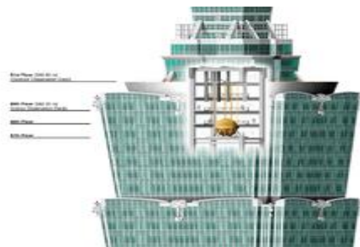
Рис. 3. Инерционный демпфер на высотном здании Тайбэй 101
