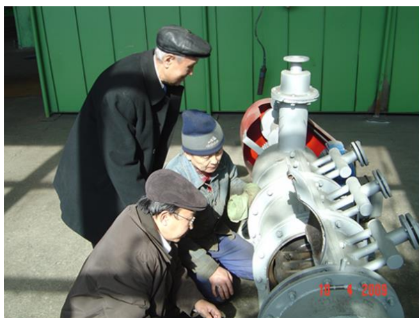
а) Регулировка зазора между ножами в измельчительно –сушильной установке (ИСУ)
