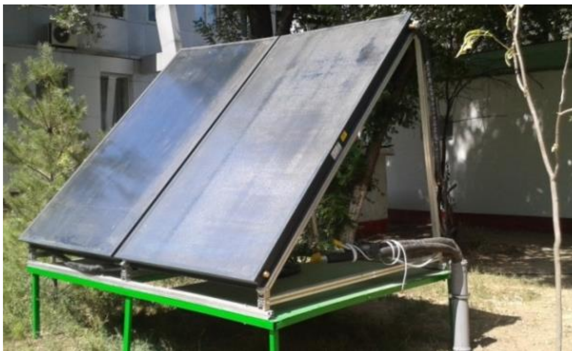
Рис. 2. Натурная модель солнечного гелиоколлектора
