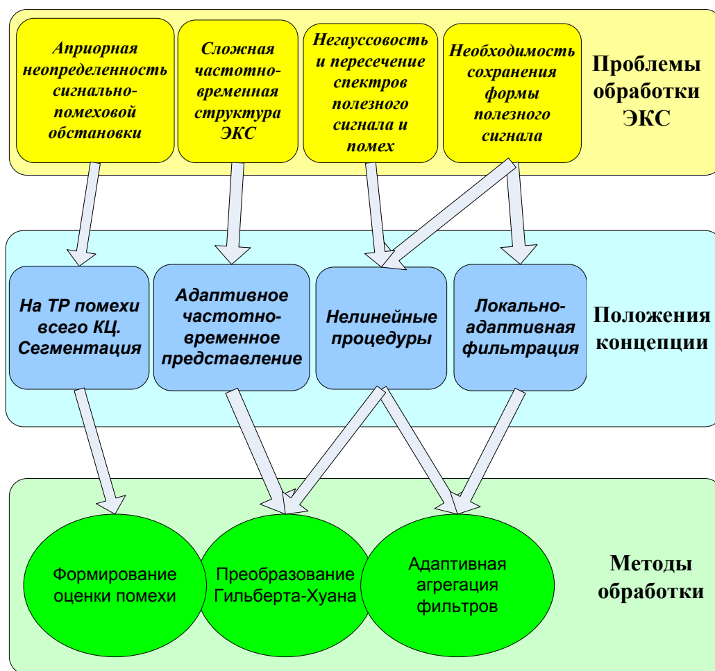
Рис. 1. Концепция помехоустойчивой обработки ЭКС в условиях двигательной активности
