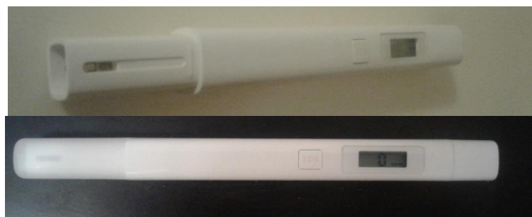
Сурет 1. Су сапасын бақылайтын анализатор
