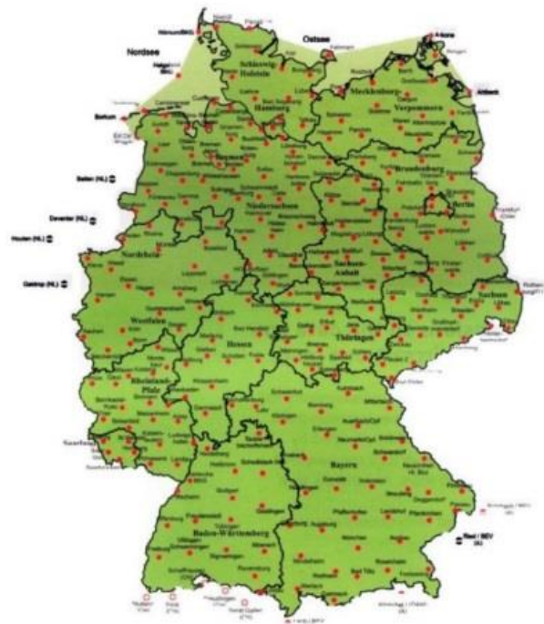
Рис. 2. Национальная сеть базовых ГНСС станций SAPOS государственной геодезической службы Германии AdV
