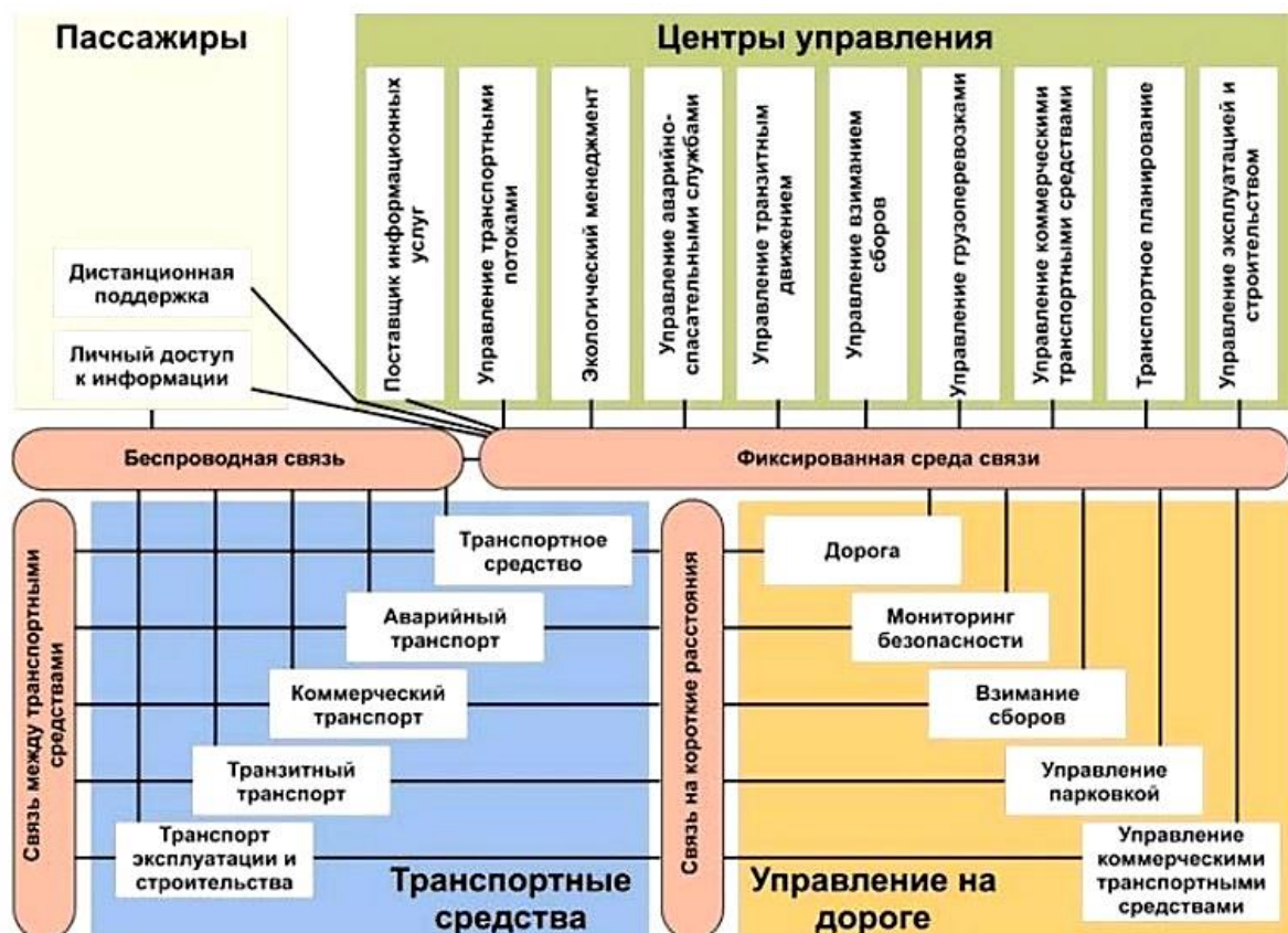
Рис. 1. Схема физической и коммуникационной архитектуры ИТС США
