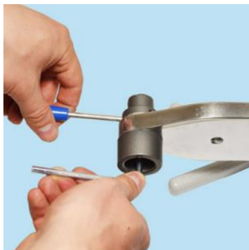
Рисунок 3. Установка сварочных насадок на паяльник
