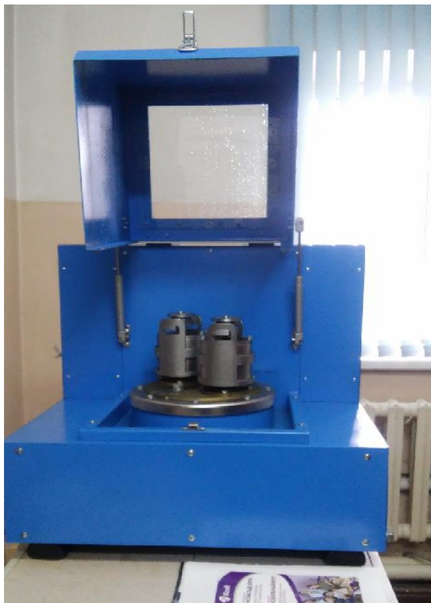
Рисунок 4. Шаровая планетарная мельница типа «Агитатор 2S»
