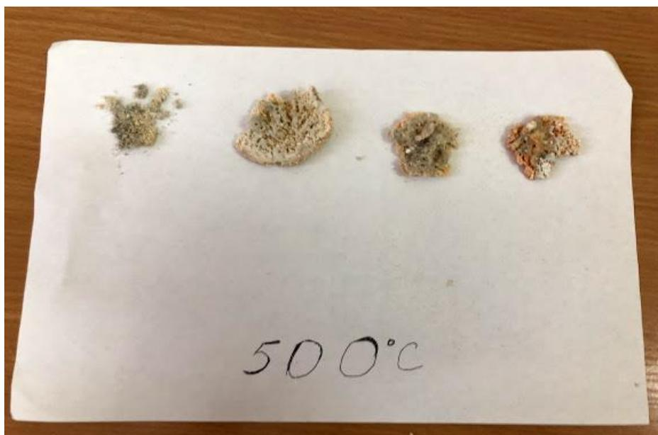
Рисунок 7. Продукты, синтезированные в трехкомпонентных системах на основе дигидромонофосфатов кальция, алюминия и жидкого стекла с добавками фосфатов железа
