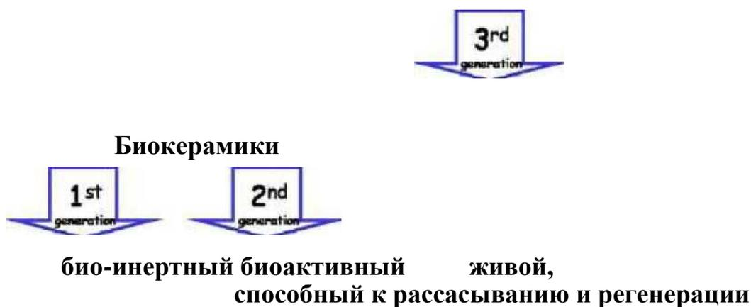
Рисунок 3. Схема дерева поколений биокерамики [3].
