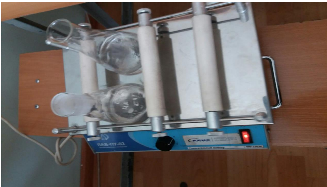
Сурет 11. 30 минут бойы шайқап араластыруға арналған ротациялық аппарат
