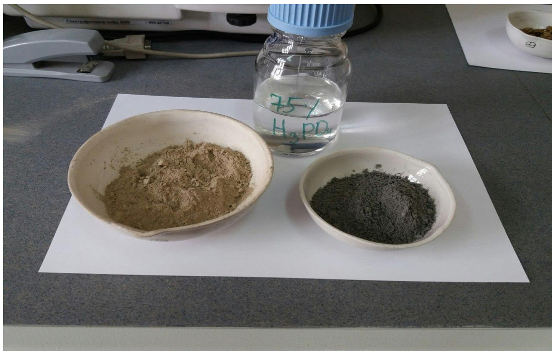
Сурет 9. Бастапқы байыту қалдықтары (сол жағында) және фосфор қышқылымен араласқаннан кейінгі жартылай өнім
