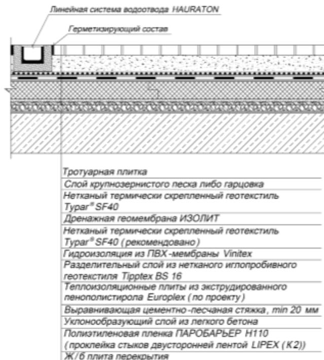
Рисунок 21. Устройство эксплуатируемой кровли
