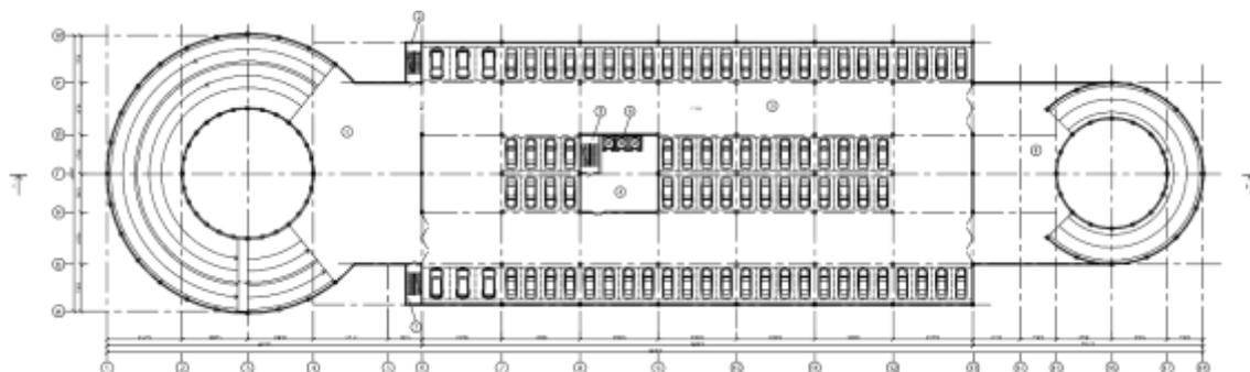
Рисунок 14. План паркинга на отм. -6.600
