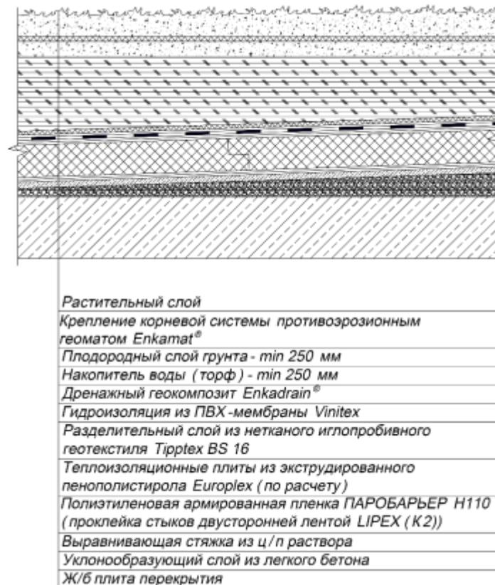
Рисунок 23. Эксплуатируемое покрытие с растительным слоем «Зеленая кровля»
