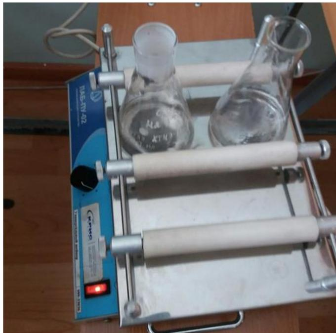
Рисунок 6. Ротационный аппарат для встряхивания в течение 30 минут.
