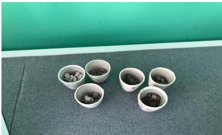
Рисунок 5. Продукты термообработки смесей фосфорной кислоты с отходами обогащения железомagnetитовой руды Соколово- Сарбайского месторождения.
