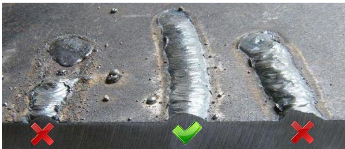
Электр доғалық пісіру кезінде дұрыс пісіру тігісі
